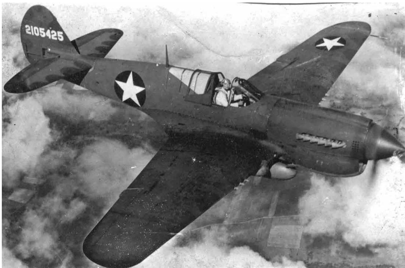
P-40 *Warhawk*. Ce monoplace est équipé d'un moteur Allison de 1 350 chevaux, refroidi par liquide (glycol) qui lui donne une vitesse de croisière de 360 km/h, maximum 550 km/h, et il est armé de six mitrailleuses d'ailes de 12,7 mm. À signaler que *Warhawk* veut dire : *Faucon de Guerre* et P-40 : *Pursuit 40*, soit chasseur 40.
