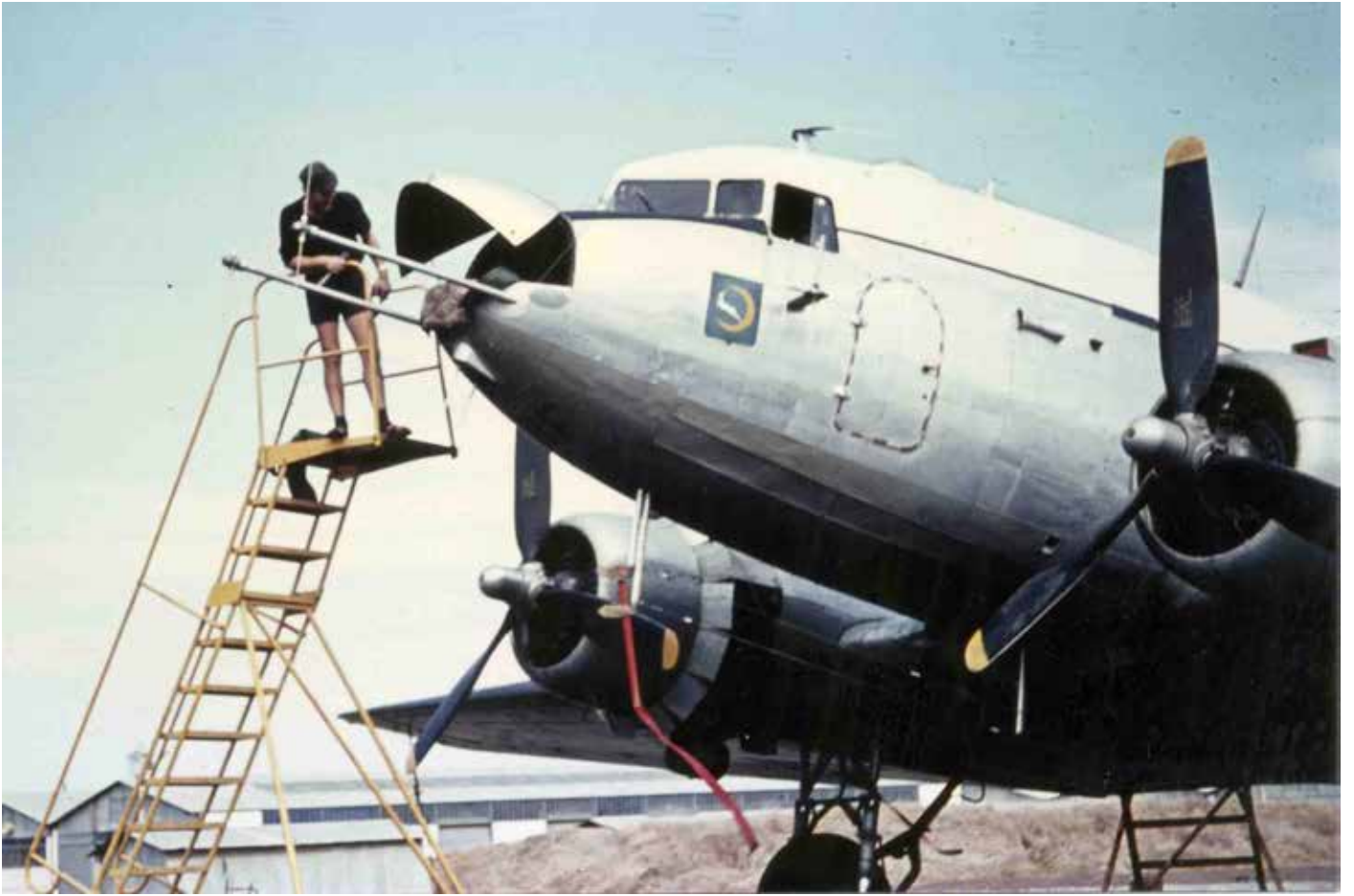
▲ ▼ C-47 du GLA 45 équipé d'antennes de homing
