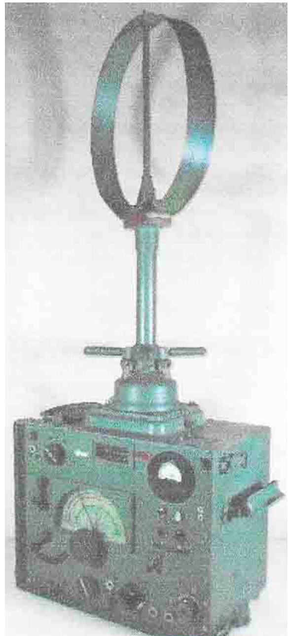
▲ Radiogoniomètre CSF RG-1 avec le cadre rotatif et l'antenne de lever de doute. Il pèse 29,1 kg avec cadre et 16,5 kg sans cadre
