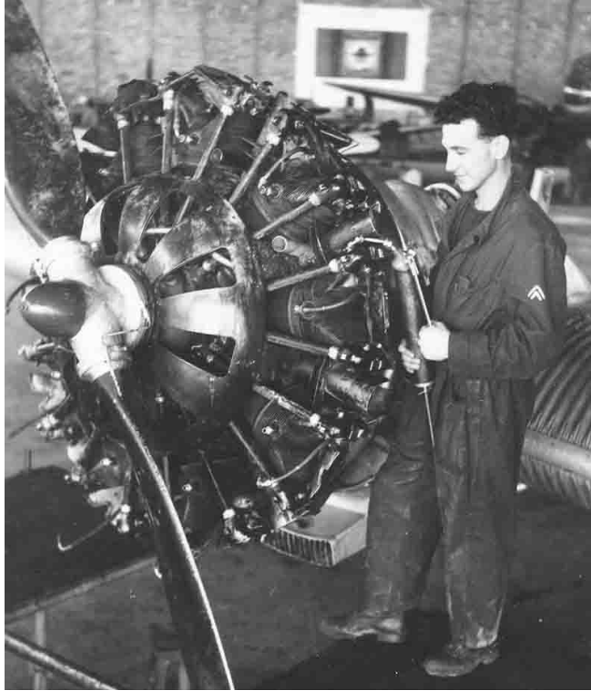
4S – Le QM Gaet au travail sur le moteur BMW 132 (SNECMA) d'un Ju 52
