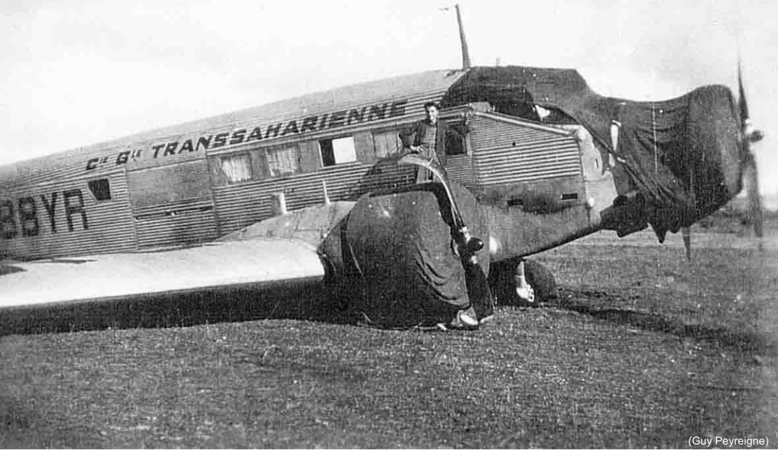
Aérodrome de Mascara-Saint André – La Compagnie générale Transsaharienne a ouvert une ligne éphémère vers Mascara, le Ju 52 a fait les frais d'une piste un peu courte et de freins défectueux – 28 novembre 1947
