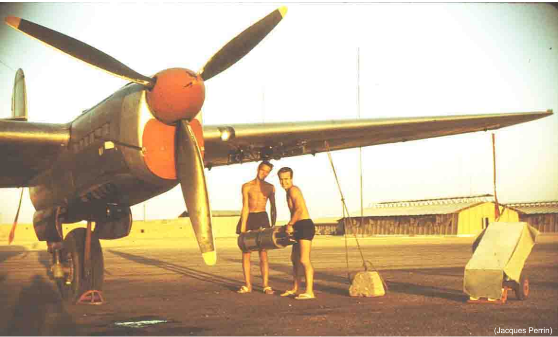
El-Abiod 1961 – Dassault 315 Flamant du GOM 86 – Mise en place d'un panier Matra 122 de sept roquettes SNEB 60 mm
