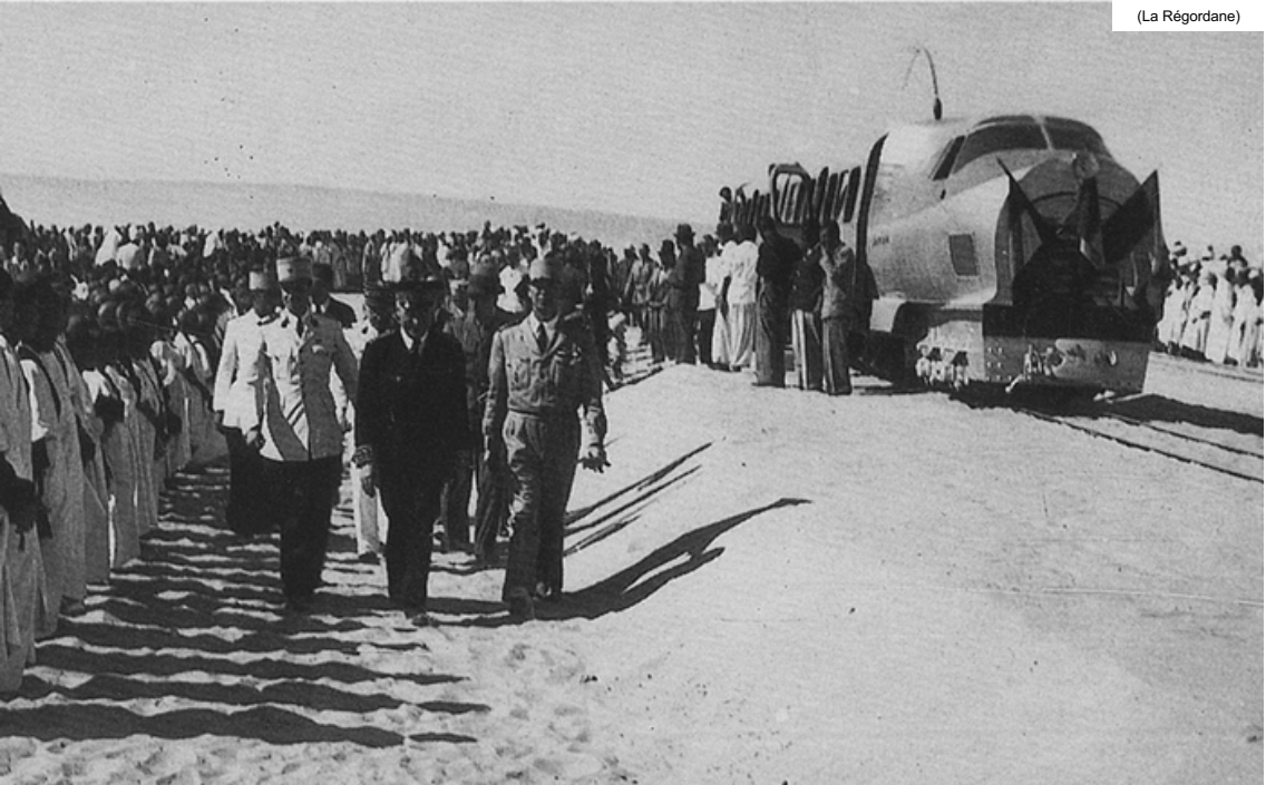
Août 1946 – Inauguration du tronçon Stil-El Oued sur la ligne Biskra-Touggourt-El Oued, ultime voie de 0,60 m construite en Algérie – La rame de passagers est formée d'un locotracteur Billard N° 5 et de deux remorques légères surmontées d'un fuselages de Dewoitine 338.
