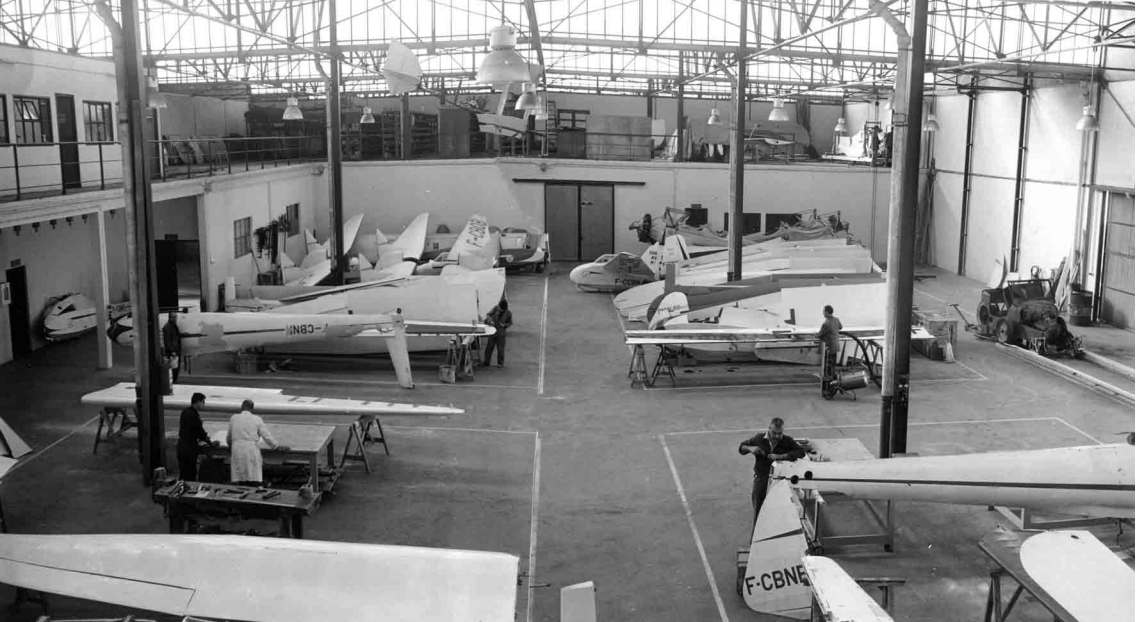
L'atelier du SALS-A 103, rue Sadi-Carnot à Alger, dirigé par Antoine Lasserre. Il assure l'entretien des planeurs, des remorqueurs et des treuils. Un planeur genre Chanute est visible au plafond, ainsi que des cellules de Morane-Saulnier 315 et un treuil. L'atelier a construit une série de DACAL 105 et 106, un Minicab, des Fauvel AV-36 Aile Volante et des Wassmer WA-21 Javelot (Lucien Saucède)
