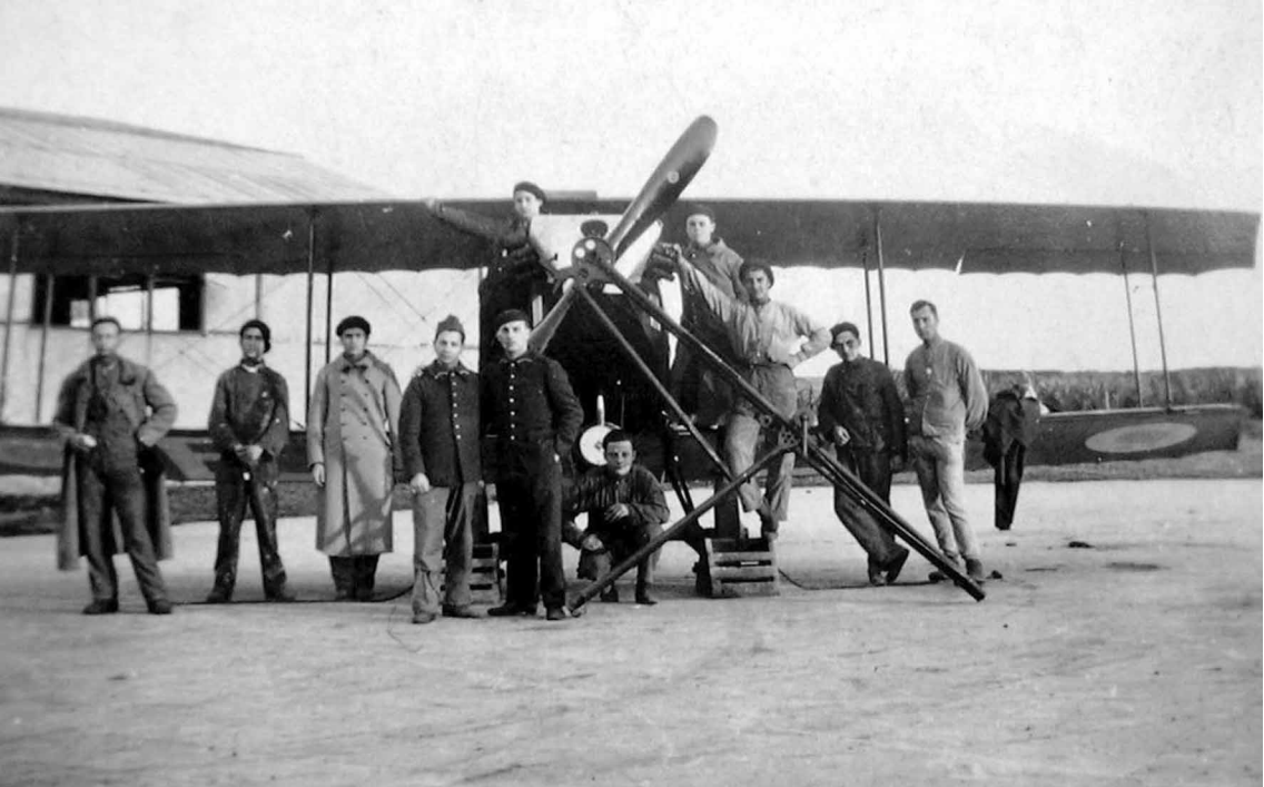
Le 2 ème GAA utilise des Caudron C 59 démarrés par ce curieux dispositif (Guy Berret)
