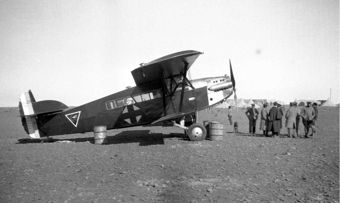
Potez 29 sanitaire de l'escadrille VR 548 du 2 ème GAA. Cet avion de transport léger est très utilisé pour accompagner les escadrilles dans leurs déplacements (Henri Lafite)
