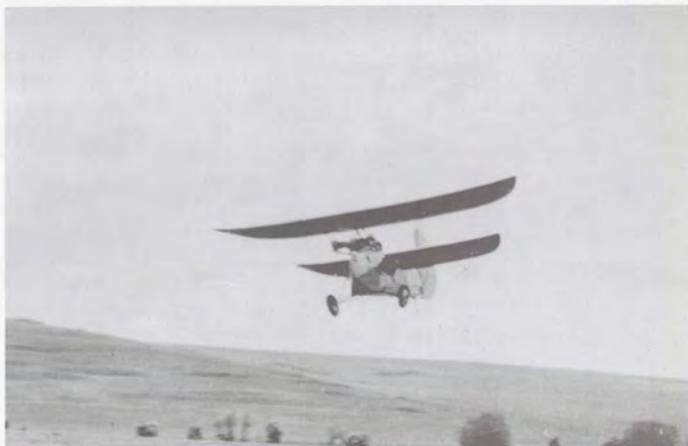
place de la manivelle et le refroidissement par eau est assuré par un imposant radiateur dont le principal inconvénient est de masquer la vue du pilote. Des roues de Simca 5 achèvent de donner la touche "automobile" et, à 1 800 tours-minute, Ernest Duc arrive à quitter le sol pour une ligne droite à basse hauteur.
