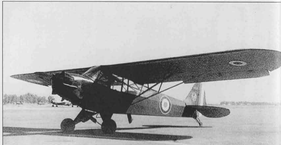
Piper L-4H du GAOA 4 de Fès. C'est l'un des six appareils révisés et remis en état par la Section de réparation de l'aviation d'artillerie en Allemagne puis mis en caisse à Baden-Oos pour être expédiés vers le Maroc. (coll. Dominique Dupin)
