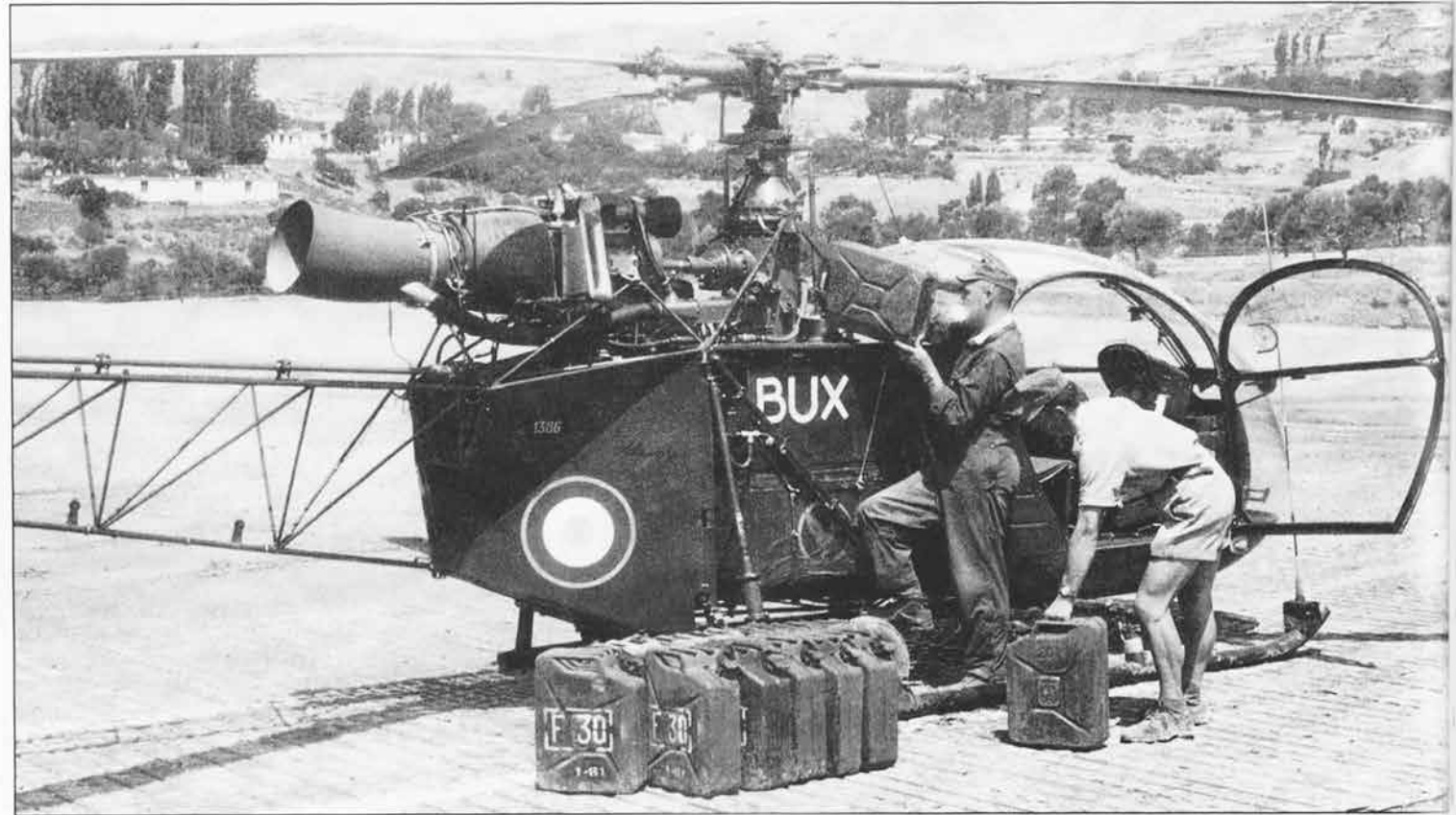
Avitaillement en carburant TRO d'une Alouette II du PMAH 21 ème DI en détachement à Arris. Un total de 575 litres assureront entre deux et trois heures d'autonomie suivant la charge et le profil de la mission. (Louis Chupin)
