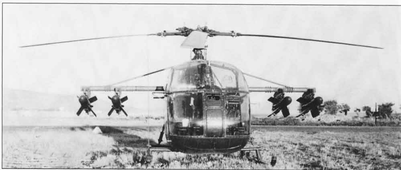
Alouette II du 1 er PMAH 21 ème DI armée de missiles filoguidés SS. 11. (Robert Cortès)
