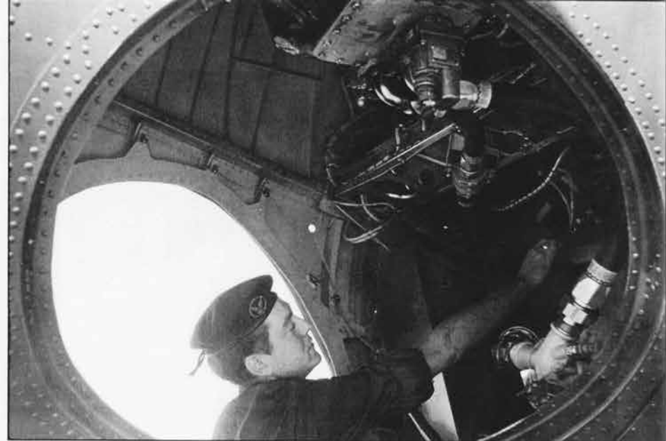
Dans le trou d'homme, sous la BTP arrière, visite de contrôle de divers circuits hydrauliques avant un départ en mission. (Jean Gomanne)
