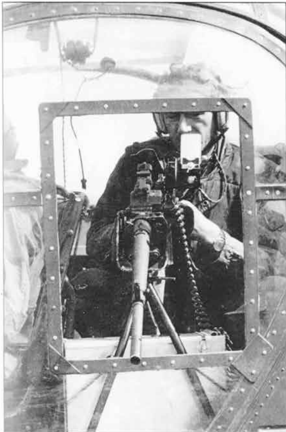
Le PMAH 19 ème DI fut chargé à l'automne 1961 de l'expérimentation de la mitrailleuse AA 52 montée en sabord sur Alouette II, une association qui présentait l'avantage d'être employé comme appareil d'observation et de commandement en vol classique avant la possibilité de proposer rapidement un appui feu léger sur un objectif à sa mesure.
