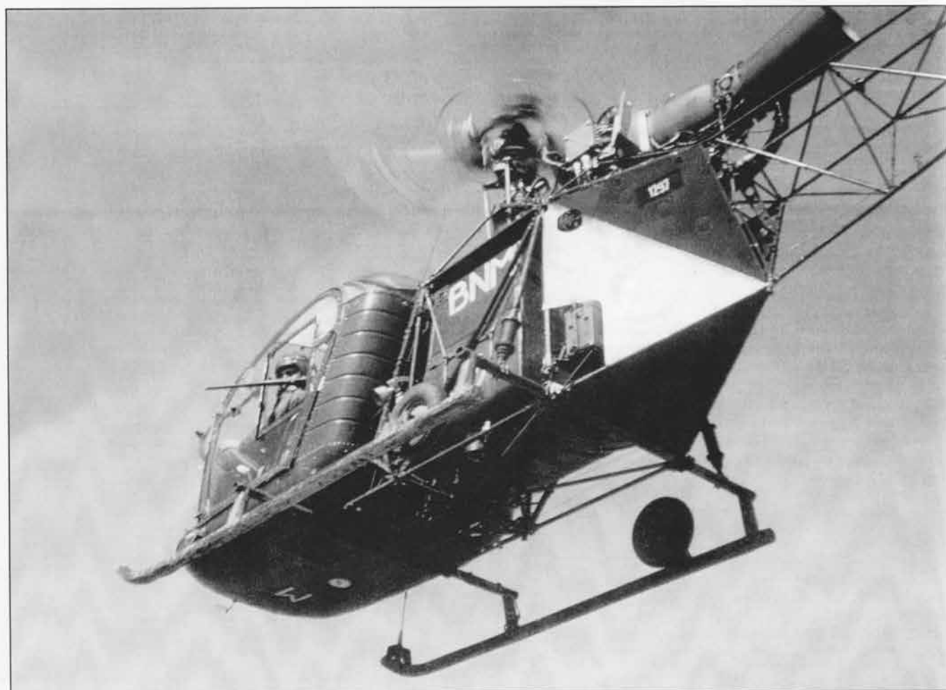
Alouette II n° 1297 (F-MBNM) du PMAH 19 ème DI armée d'une mitrailleuse AA 52 en sabord. (François de Pitray)
