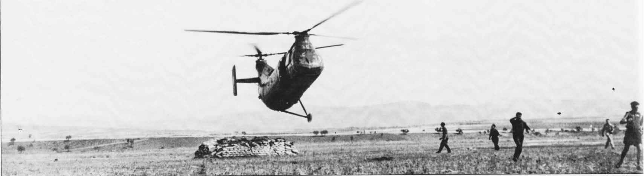
Recueil d'un H-21C victime de la rupture du train arrière droit en opérations. Une vingtaine de berceau de crash était répartie sur l'ensemble de l'Algérie, éléments destinés à recueillir en toute sécurité les "Banar" souvent victimes de problèmes de train d'atterrissage avant ou arrière lors de posers sur les pitons. (Jean Coispeau)
