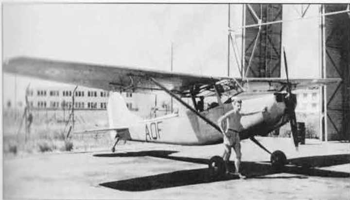
Inursion d'un L-19E de GALAT 3 d'Alger sur le terrain de Sidi-Ahmed en Tunisie en juillet 1961. Au niveau de la mer, l'appareil pouvait franchir 650 km à une vitesse de croisière de 160 km/h. (Pierre Tabart)
