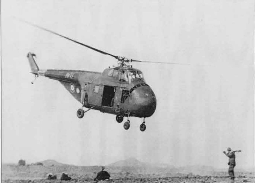
Poutre inclinée vers le bas, plan fixe droit, absence de bec de capot : c'est le H-19. (ALAT)
