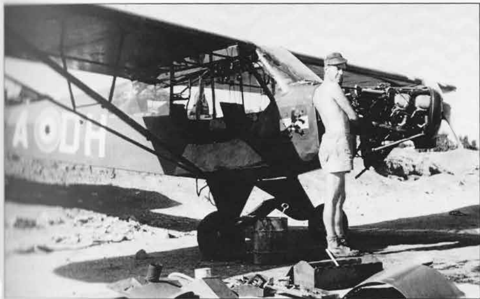
Entretien du Lycoming d'un L-21 du PA 13 ème DI à Aflou en 1958. (Michiel Dupont)
