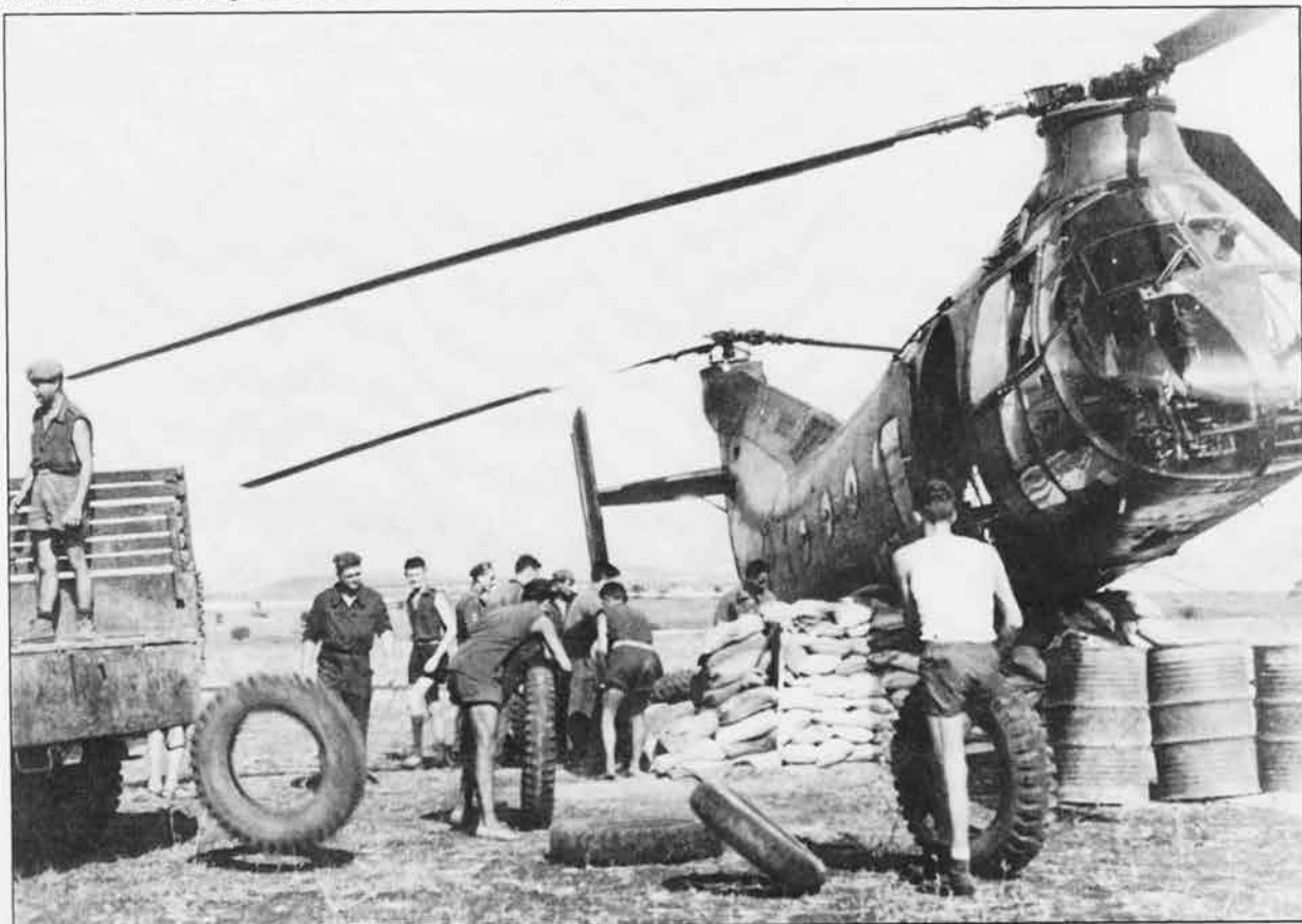
Recueil d'un H-21C victime de la rupture du train arrière droit en opérations. Une vingtaine de berceau de crash était répartie sur l'ensemble de l'Algérie, éléments destinés à recueillir en toute sécurité les "Banar" souvent victimes de problèmes de train d'atterrissage avant ou arrière lors de posers sur les pitons. (Jean Coispeau)
