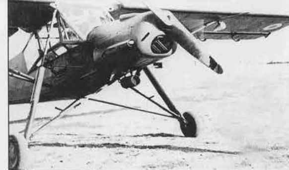
Consommant 70 litres/heure, le moteur Argus permettait au Criquet de tenir l'air pendant plus de 4 heures. (coll D. Dupin)
