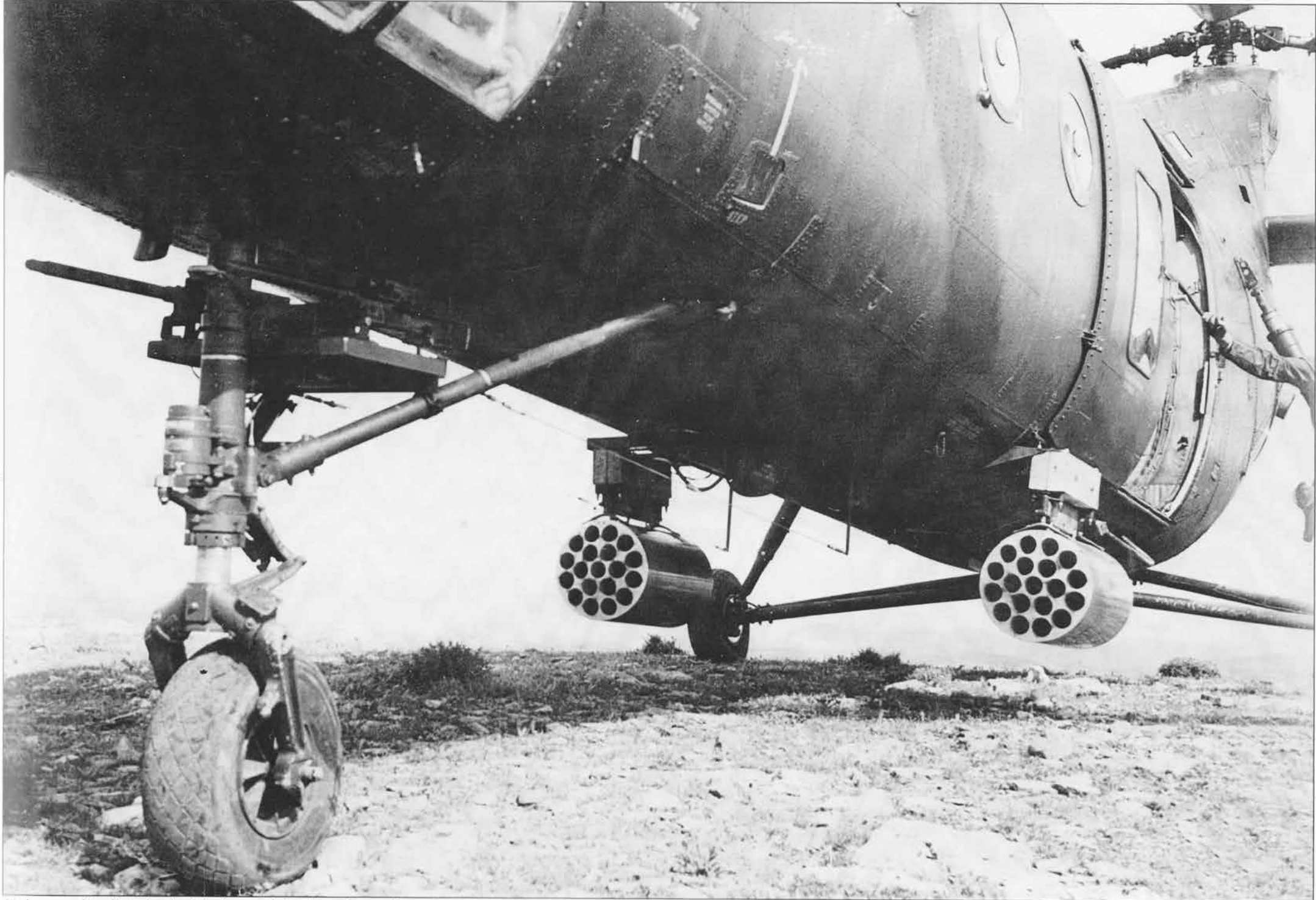
Fixés aux points d'attache destinés à recevoir les réservoirs extérieurs du H-21, les lance-bombes Alkan type 251 permettent l'accrochage des lance-roquettes. (coll Alain Crosnier)
