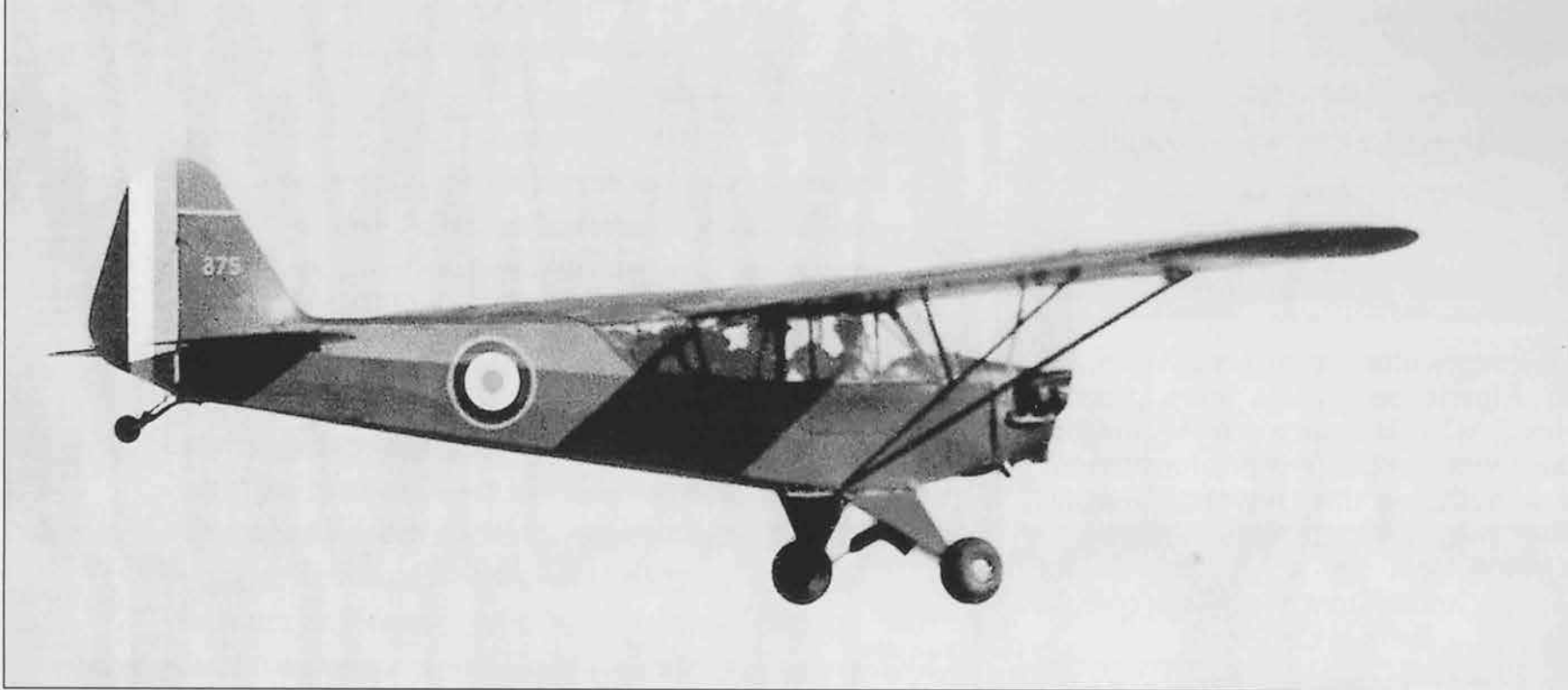
Piper L-4H n° 44-79875 du GAOA 3 de Sétif, en service dans ce groupement d'aviation d'observation d'artillerie en 1948. Les têtes de cylindres du moteur sont apparentes, un signe distinctif pour différencier le L-4 de ses successeurs, les L-18C et L-21B/BM. (René Chanal)
