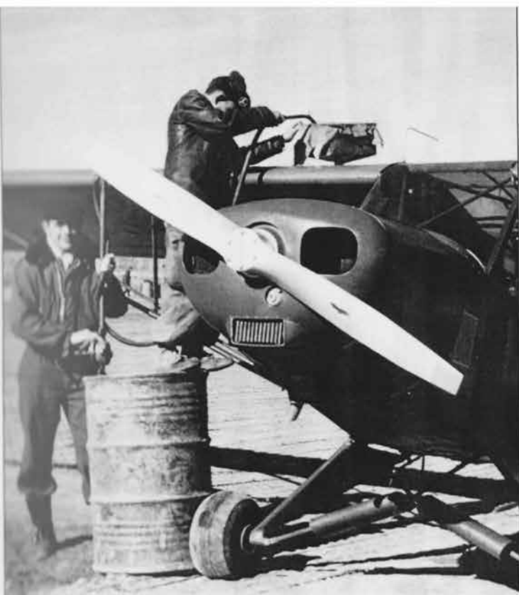
Utilisation d'une peau de chamois par cet équipage du PA 4 ème DIM à Afou pour filtrer l'essence destinée à leur L-21BM. (Georges Le Mer)
