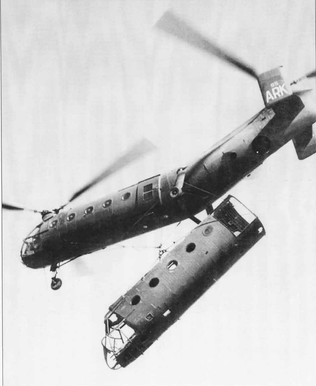
Récupération dans le Hodna en juillet 1958 du fuselage d'une "Banane" dont la plupart des équipements ont été préalablement démontés pour servir de rechanges par la suite. (Pierre Grodard)
