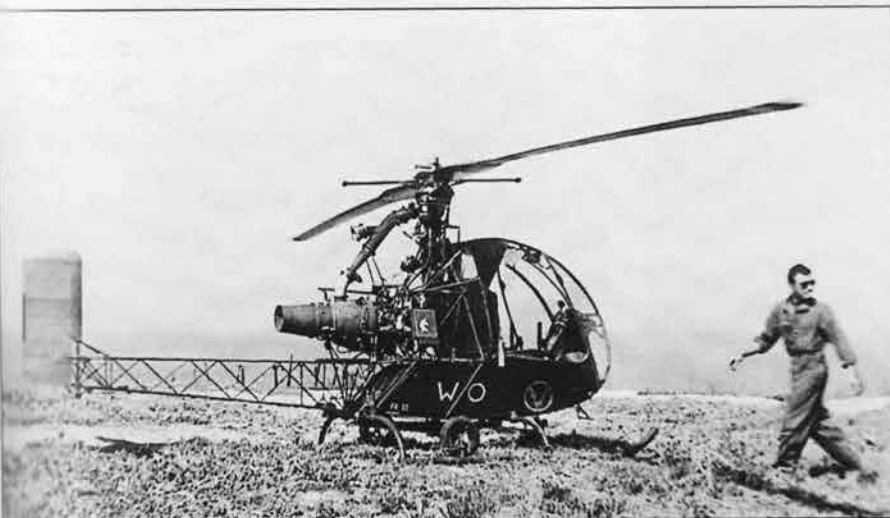
Sur hélicoptère, le pilote se tient à droite avec, en main gauche entre les deux sièges, le manche "collectif" pour la montée et la descente ; en main droite devant lui, le "cyclique" pour diriger l'appareil dans le plan horizontal. (coll Jacques Moulin)
