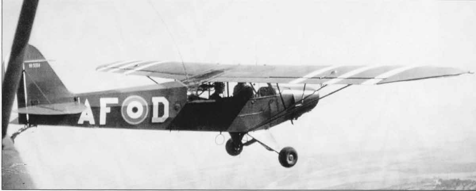
Piper L-21BM du 1 er PA de la 12 ème DI, un peloton opérant depuis Tlemcen-Zenata. Les bandes blanches sur la voilure contribuent au repérage de l'avion par les chasseurs lors des missions d'appui-feu. (Bernard Seguin)
