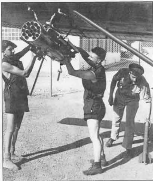
Chargement du LR 181et des roquettes fumigènes sur Cessna L-19E. (Jean-Pierre Meyer)
