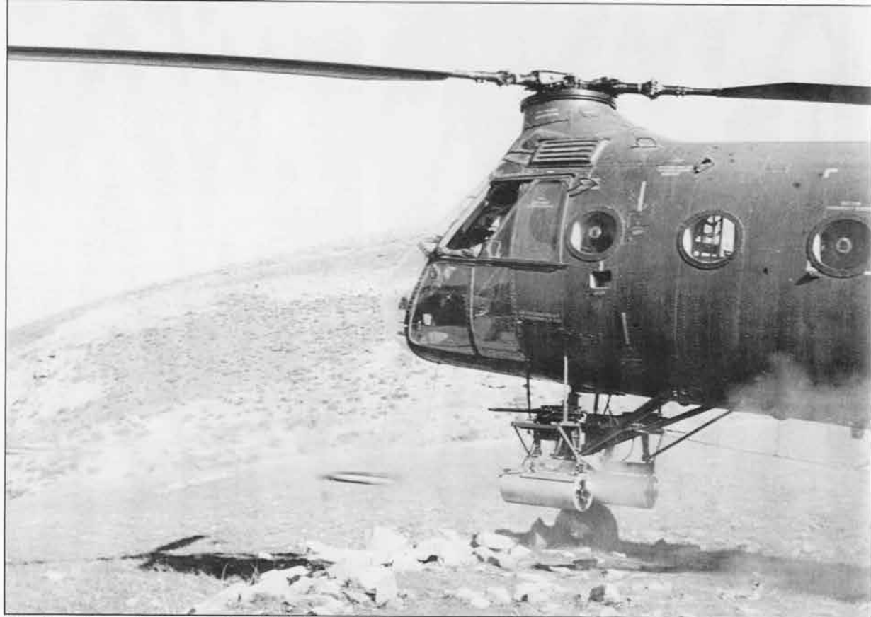
Tirs d'essais avec lance-roquettes MATRA type 122 (7 roquettes de 68 mm) en février 1958. (coll Dominique Dupin)
