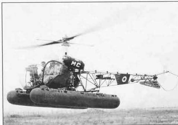
Agusta-Bell 47G-2 équipé de flotteurs du GAOA 5 en 1956 à Tunis El-Aouina. (Ange Baggioni)
