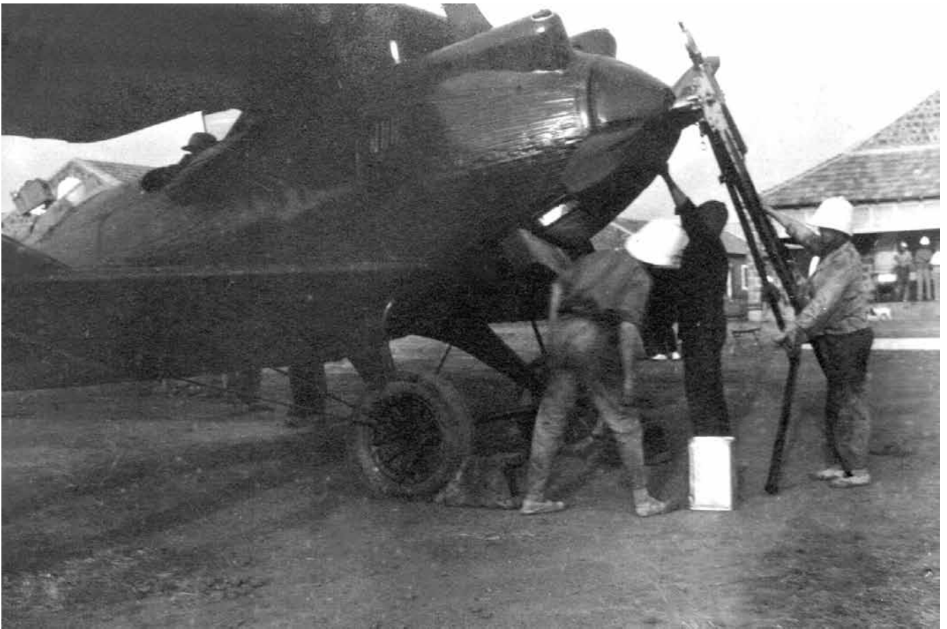
Mise en route à Dakar avec le démarreur à sandow (Jean-Paul Bonora via F-X. Bibert)
