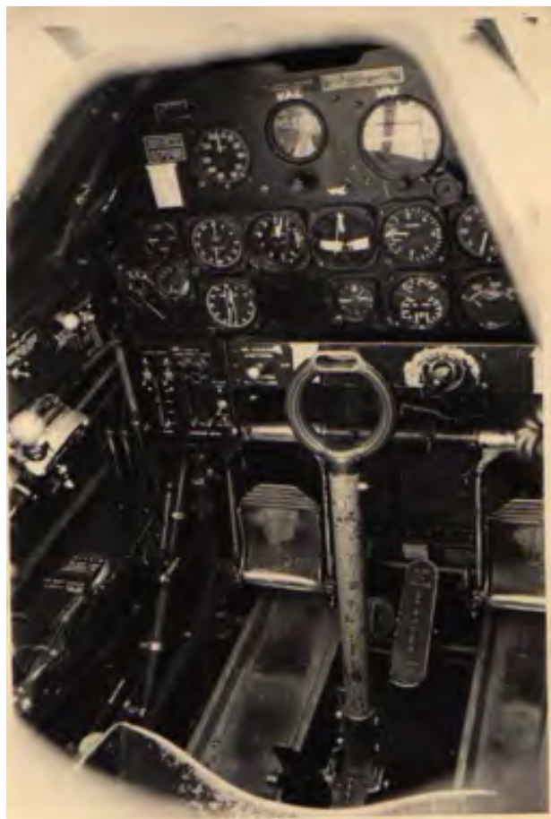
Le T-6 a été utilisé à Marrakech en versions T-6D, T-6G et T-6H (Harvard). Ci-dessus, le poste de pilotage du T-6H avec le sommet du manche en anneau
