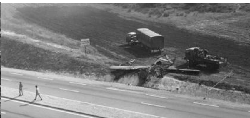
Le 21 septembre 1977, le Broussard n° 271/BPB, du 5 e RHC, décolle de l'aérodrome de Cahors pour un largage de parachutistes. Une panne survient alors. Panne due à une erreur du mécano qui a fait le plein du réservoir avec du kérosène. Le moteur n'a pas du tout aimé et s'es arrêté . L'appareil s'est crashé en bord de route et a prit feu. Sept jours plus tard, le maréchal des logis-chef Jean-Louis Bidault, mécanicien, décède des suites de ses blessures (photos via Jacques Le Bronnec).
