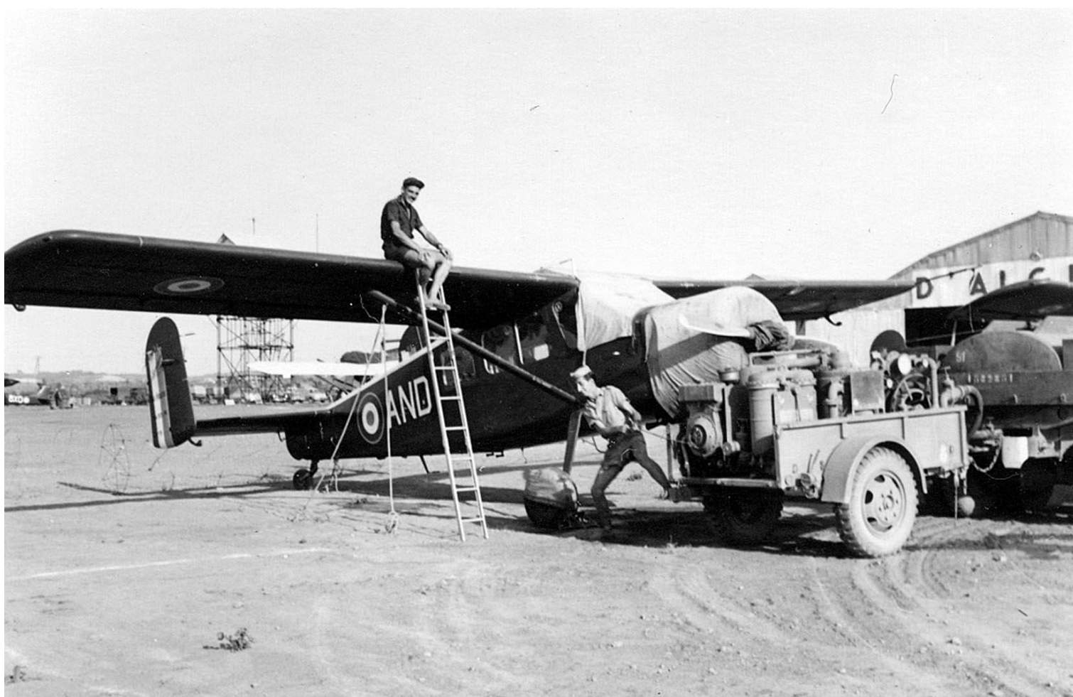
Le plein pour le Broussard n° 75M/AND du GALAT N°3 en 1958. A noter, la pompe installée sur une remorque (photo Marcel Vervoort)
