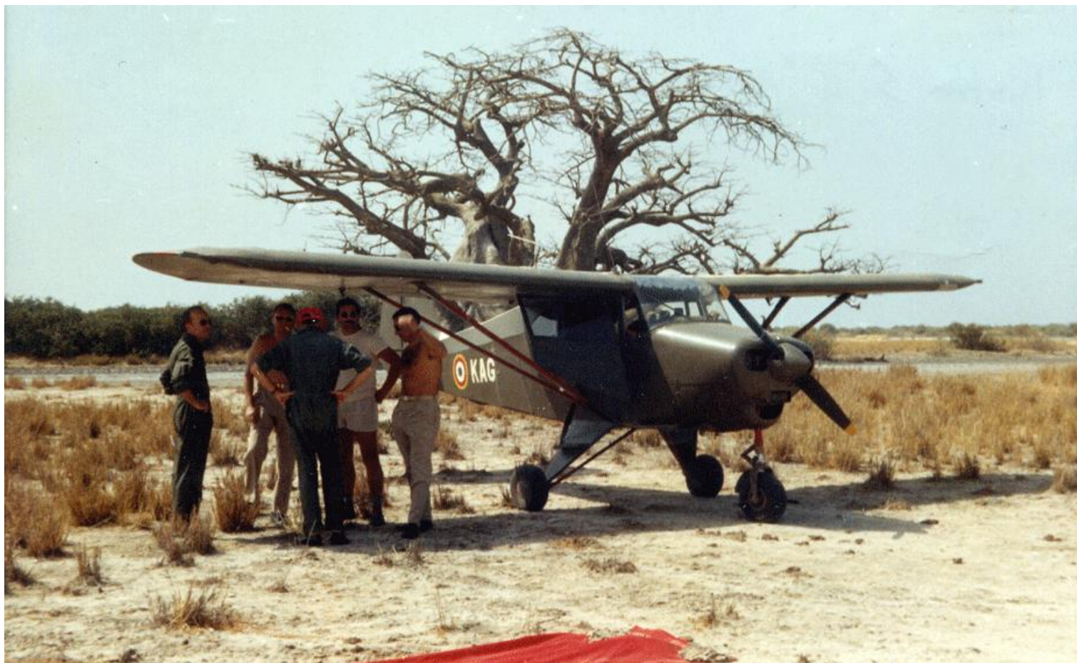
Deux Tripacer lors d'une opération à Koukou Angarana à 100 kilomètres au sud d'Abéché. L'on comprend bien ici l'avantage de l'aile haute, outre d'offrir une bonne visibilité, elle protège efficacement les pilotes du soleil. Sur l'appareil ci-dessous, à noter la porte vitrée, réalisation des services techniques de l'escadrille pour améliorer l'observation (photos Gérard Sanz).
