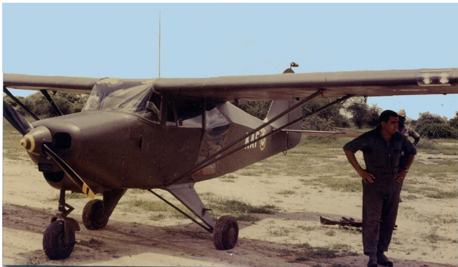
Deux Tripacer lors d'une opération à Koukou Angarana à 100 kilomètres au sud d'Abéché. L'on comprend bien ici l'avantage de l'aile haute, outre d'offrir une bonne visibilité, elle protège efficacement les pilotes du soleil. Sur l'appareil ci-dessous, à noter la porte vitrée, réalisation des services techniques de l'escadrille pour améliorer l'observation (photos Gérard Sanz).
