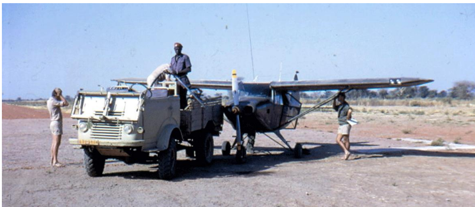
Une séquence d'avitaillement par l'ANT. vraisemblablement à Bokoro, à l'est de Mongo. On distingue très bien la porte arrière qui avait été déshabillé de sa toile et rhabillé de plexi, ce qui donnait une meilleure visibilité (photo Jean-Claude Hervé).
