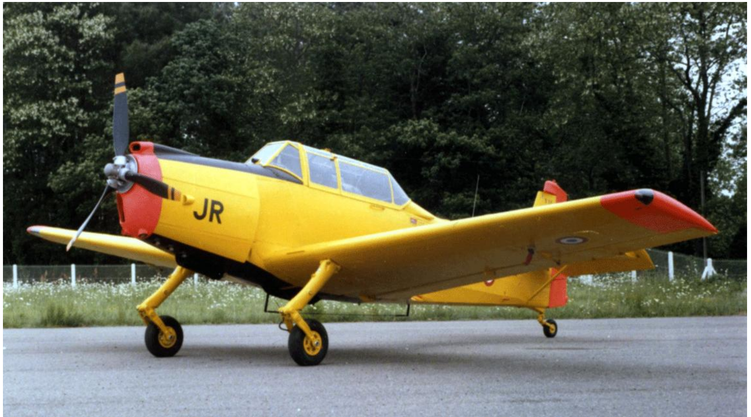
N 3202 n°68/AJR. A noter, l'hélice tripale Hartzell (photo X, collection Alain Crosnier).
