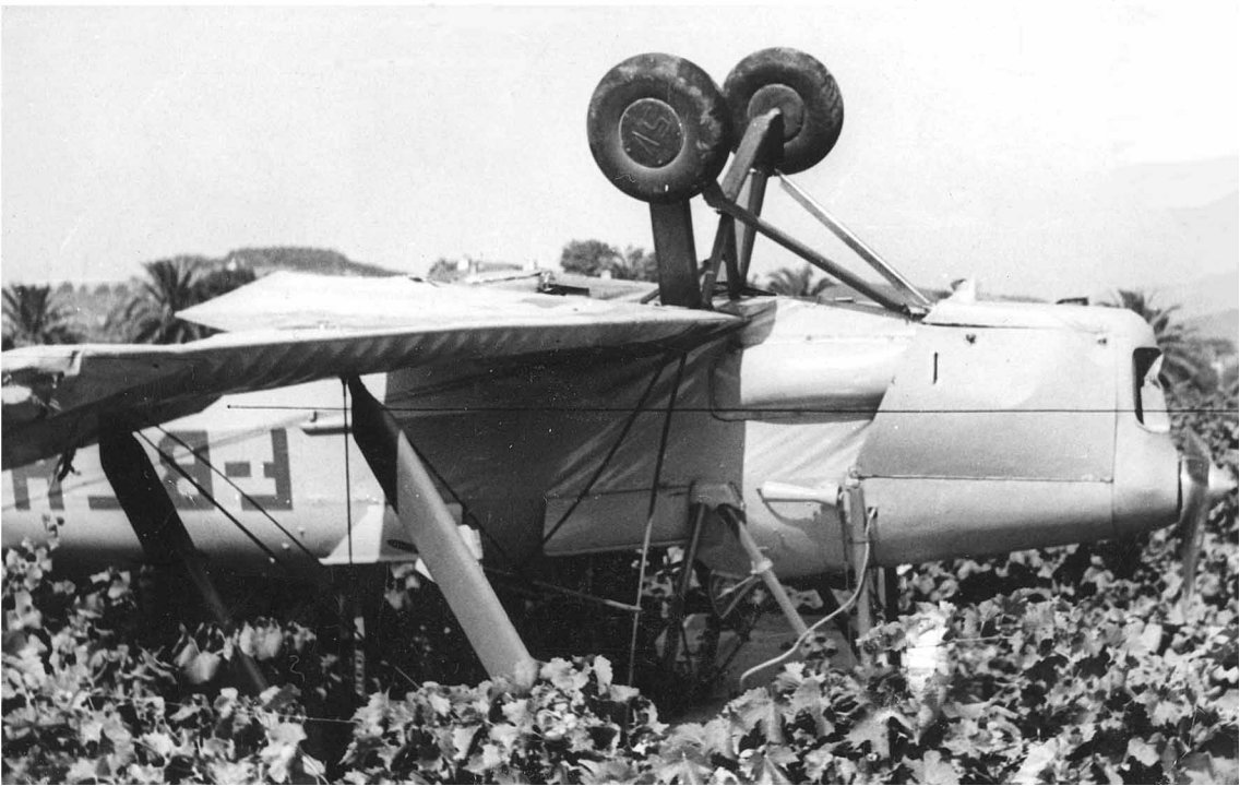
Le Tiger Moth F-BFHR dans les vignes, après avoir décollé essence fermée (Jean-Marc Lavie)
