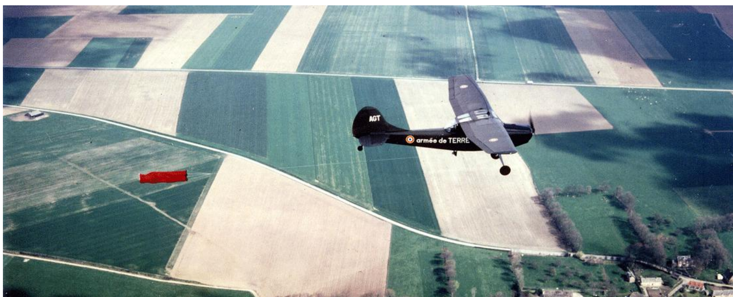
Dispositif permettant le remorquage d'une manche à air avec une cheminée sous le fuselage permettant le déroulement du câble (photo X, via Régis Biaux).
