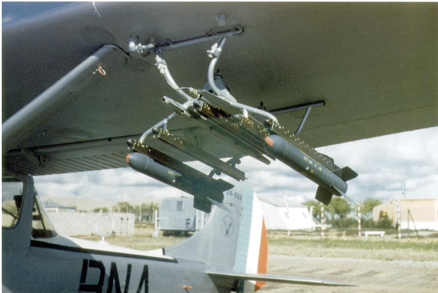
Gros plan sur les roquettes fumigènes du Cessna L-19E n° 24-559/BNA, à Sétif en 1961 (photo Pierre Tabart).
