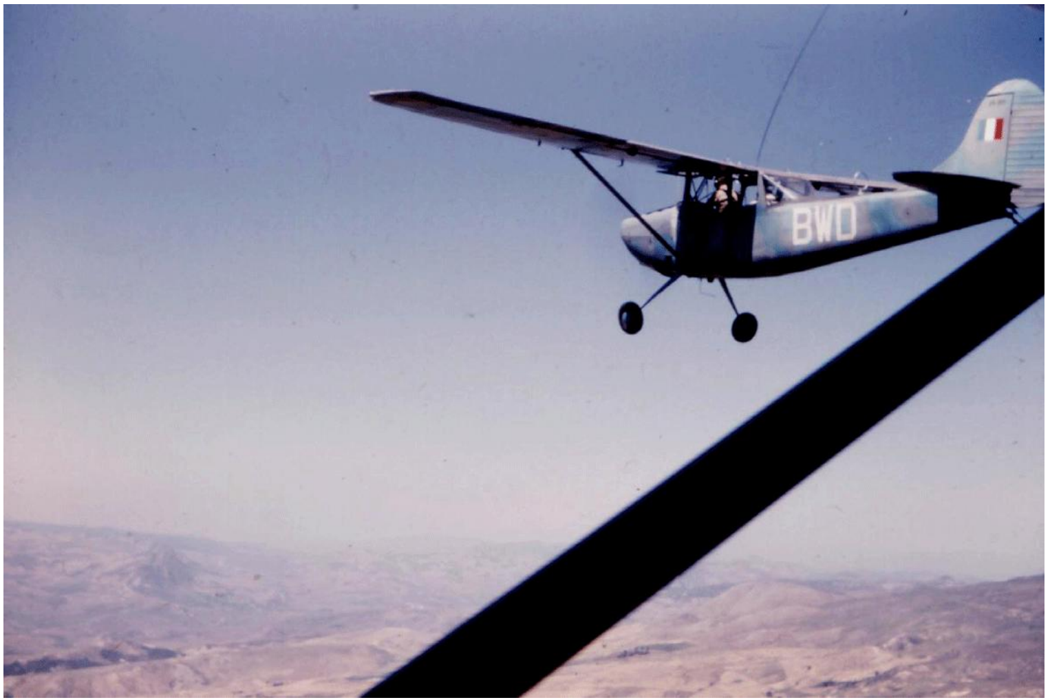
L-19E n°24586/BWD du PA de la 11 e DI, à Souk-Ahras en 1959. Cet appareil a servi pour l'essai de camouflage ciel et nuages, couleur bleue avec nuage de blanc (photo Georges Reguin).
