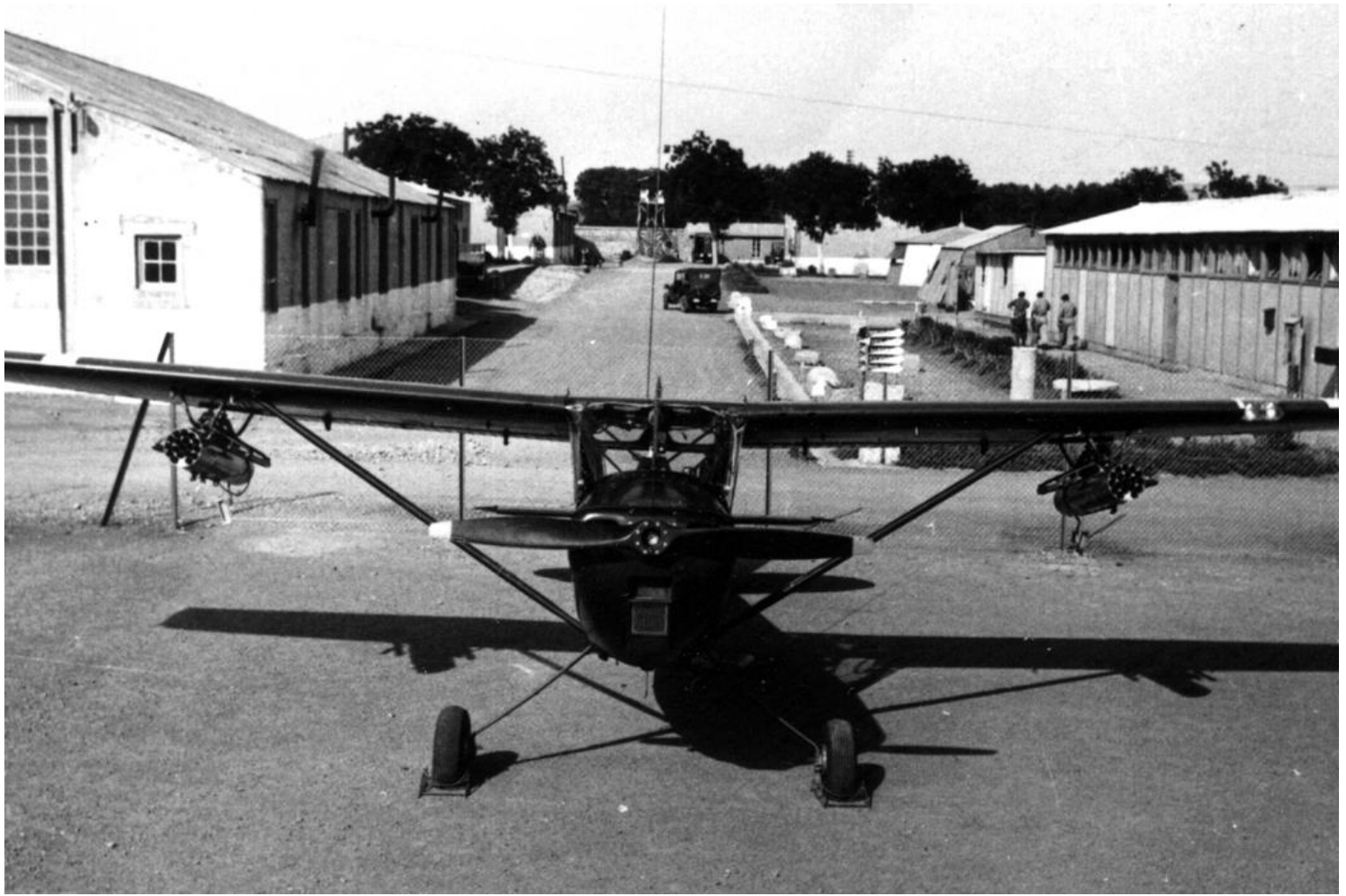
PMAH 19° DI, Sétif 1961, armement d'un L-19E avec un panier de 18 roquettes explosives de 37 mm Matra R 361, et roquettes fumigènes (photo Jean-Pierre Meyer)..
