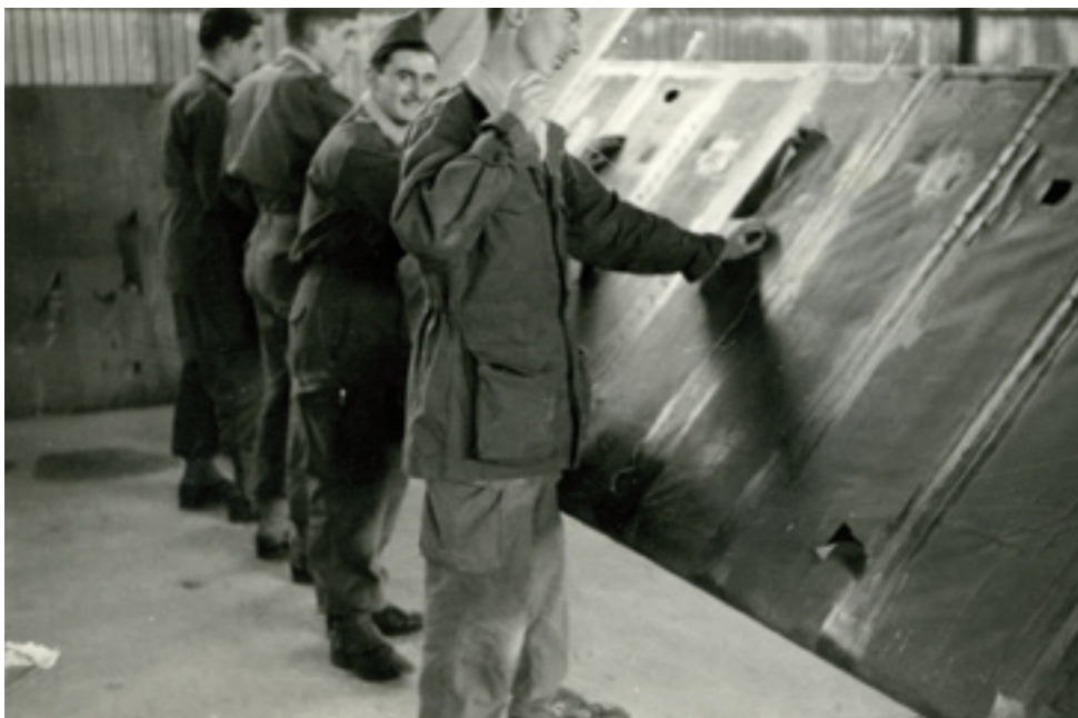
Réparation d'une aile entoilée lors du CS 1.
