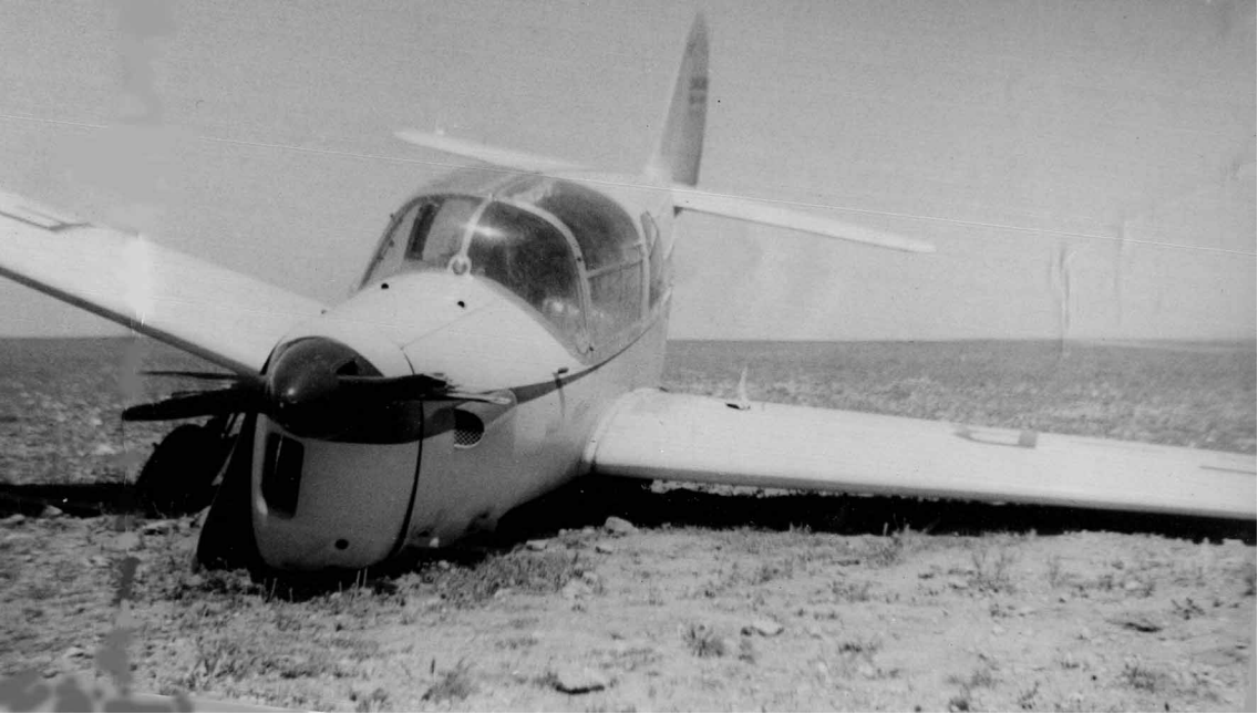
En 1949, le Norécrin victime, au décollage, de l'altitude-densité – Burdeau est à 900 mètres d'altitude et il fait chaud
