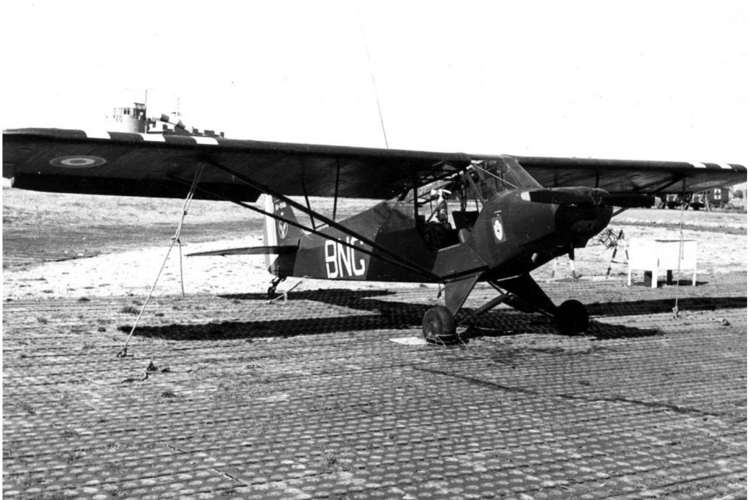
Piper L-18C n°18-1542/AKG de l'ES.ALAT, avec capot moteur modifié à cause du générateur (photo Musée de l'ALAT à Dax, via Marc Bonas).
