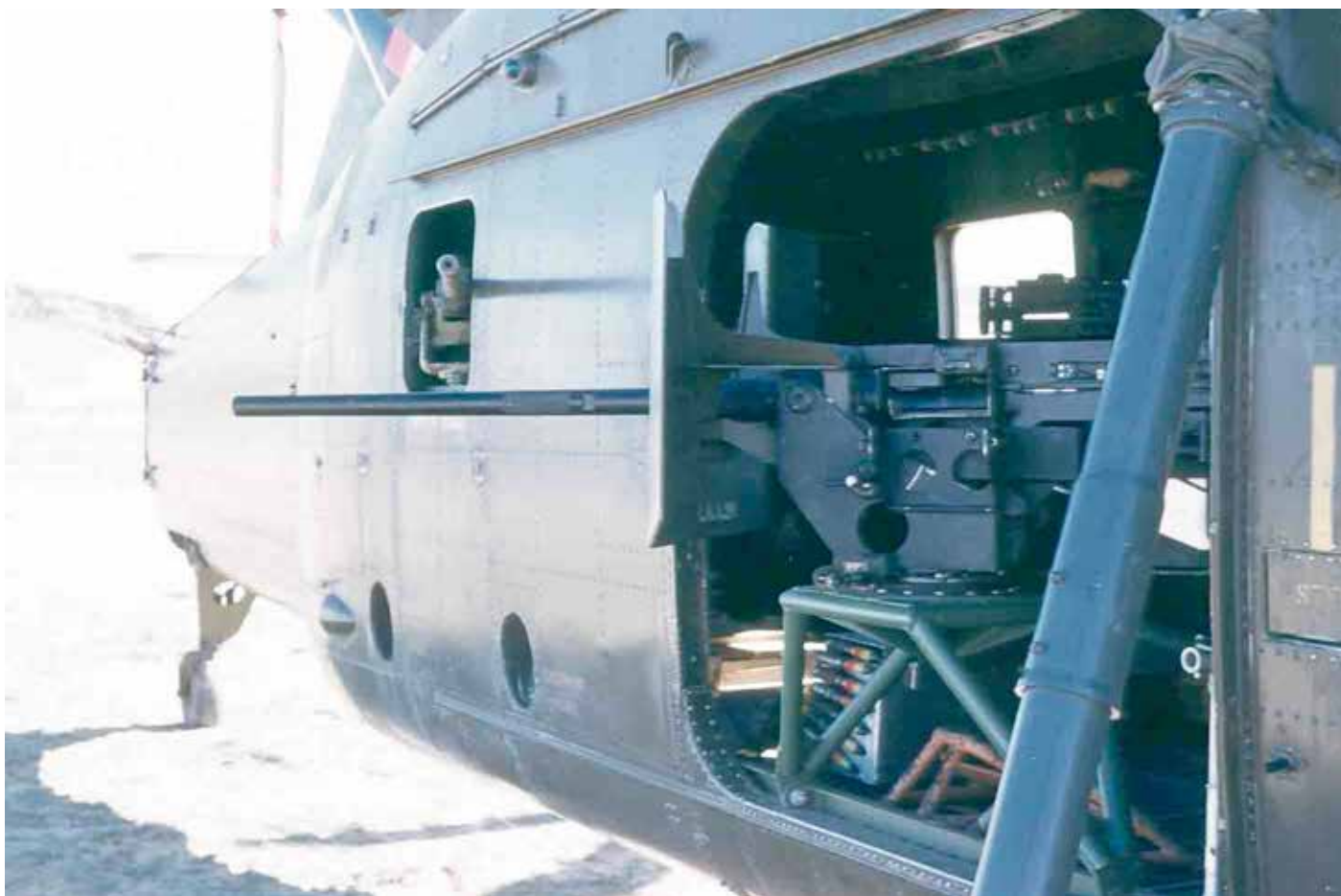
▼ Le canon de 30 mm et la mitrailleuse de 12,7 mm du H-34 Pirate
