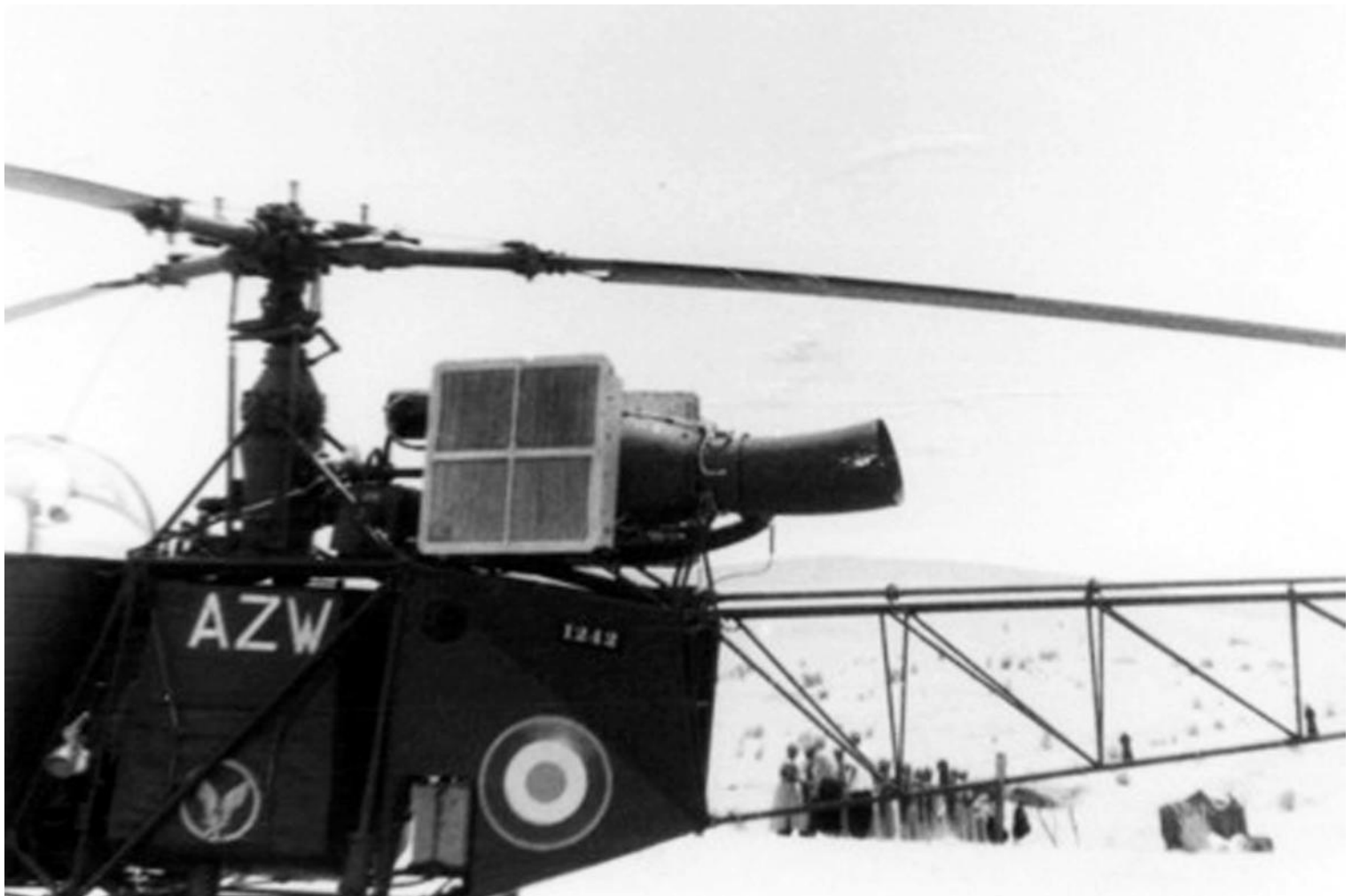
GH N°2, Alouette II n° 1242/AZW, équipée de filtres à sable pour les vols au Sahara en 1960/61 (photo Daniel Senard).
