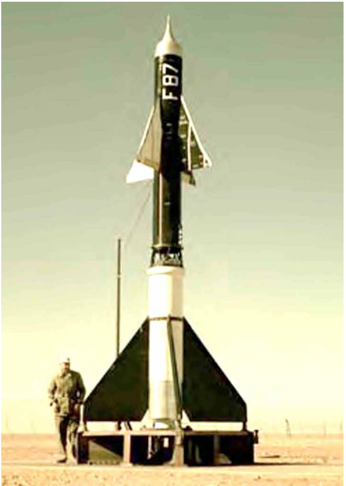
Missile sol-air SE 4400 de la SNCASE, accélérateur SEPR, propulsion par statoréacteur
