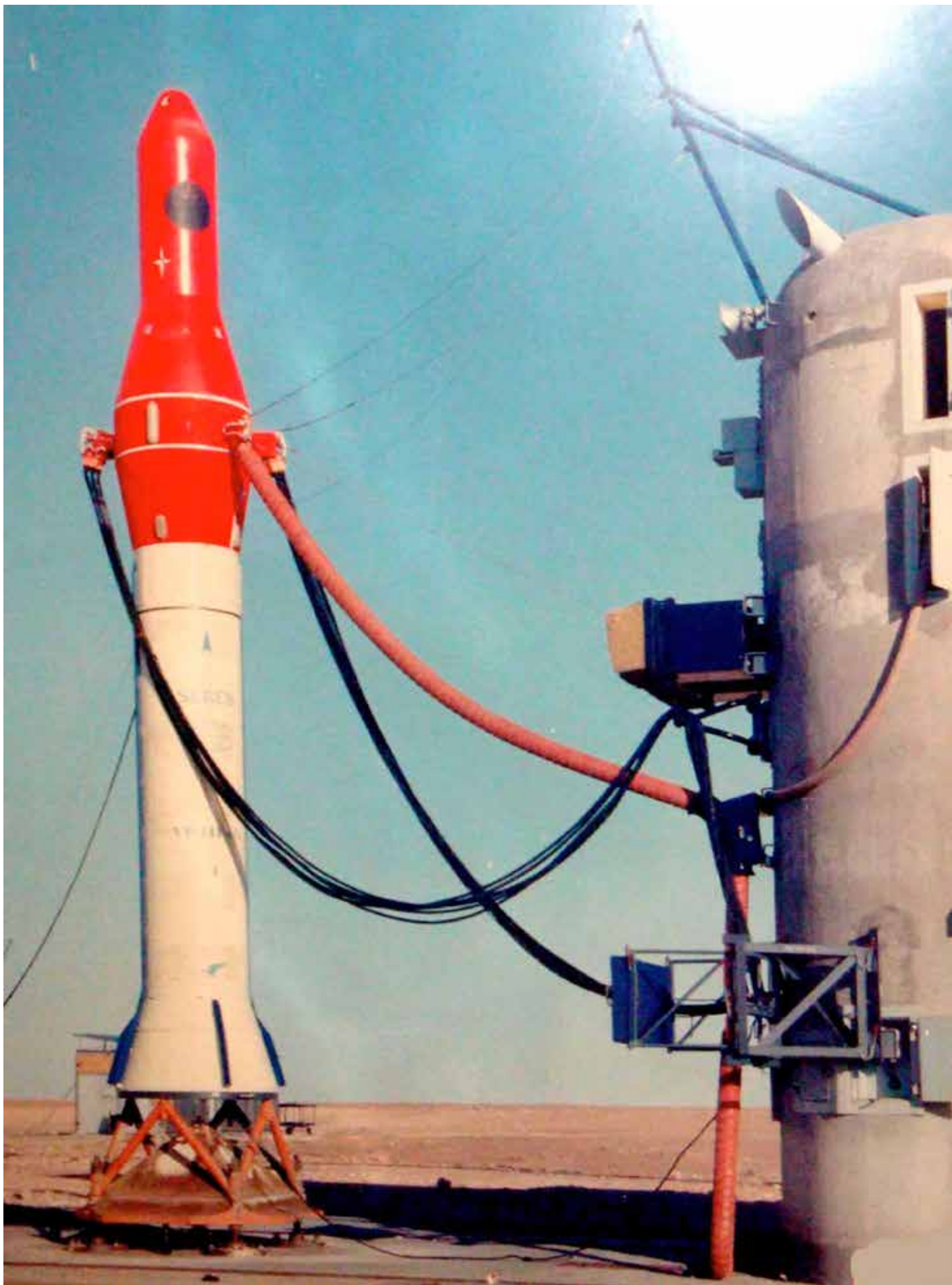
Mai 1965 - Véhicule d'essai 111LG, premier engin français guidé inertiellement par une centrale SAGEM
