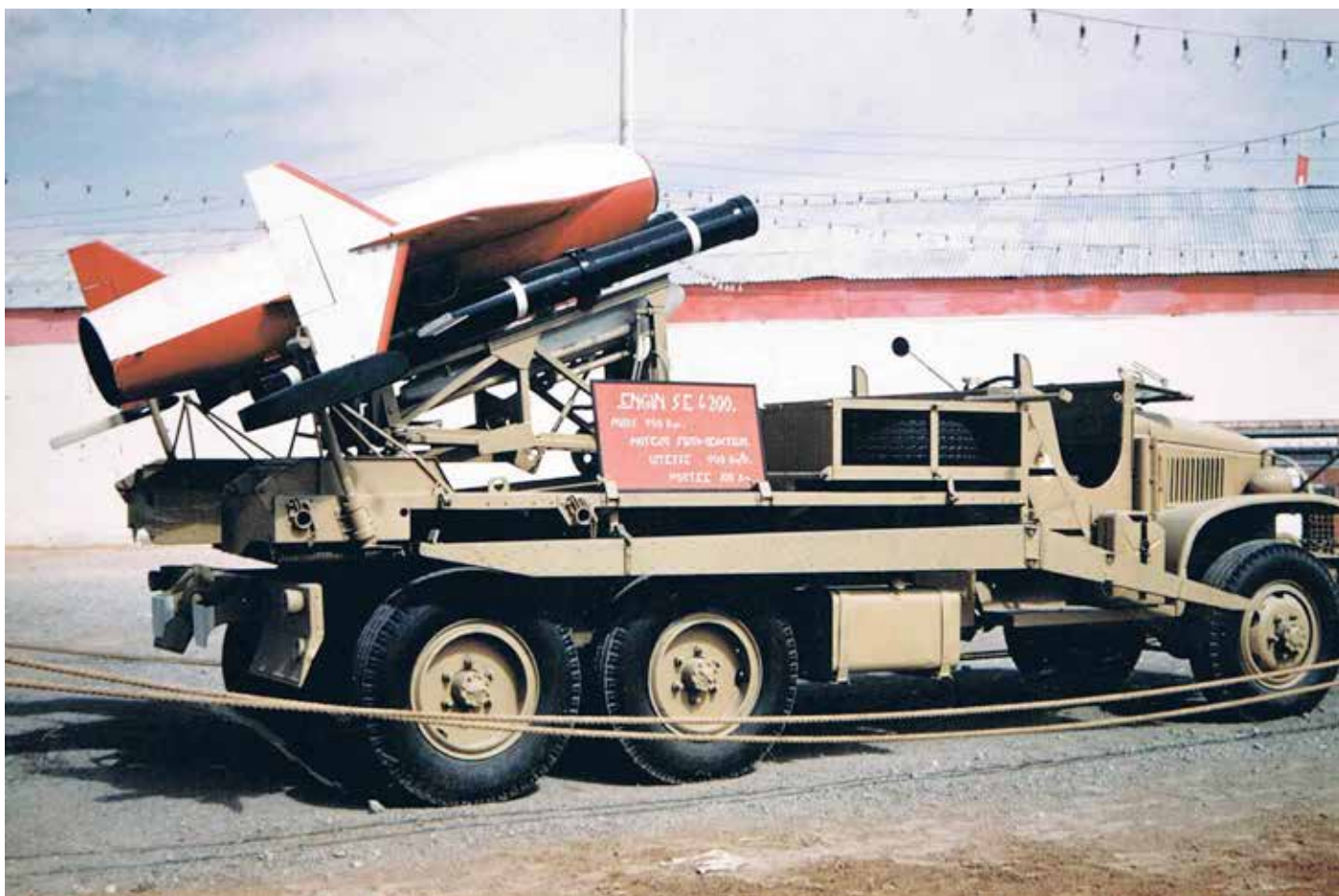
▲ Missile tactique SE 4200 de la SNCASE, accélérateur SEPR, propulsion par statoréacteur
