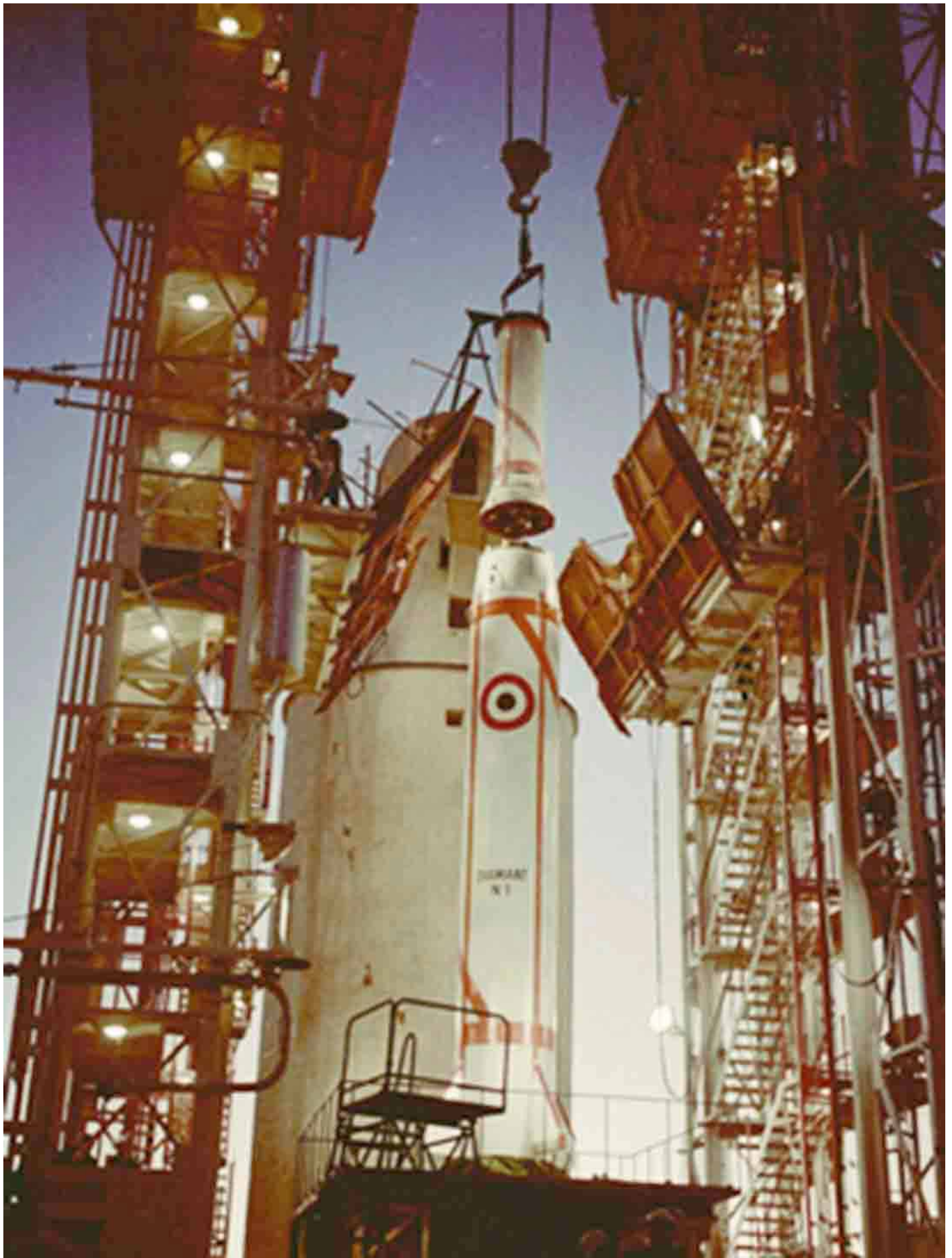
Mise en place du deuxième étage du lanceur Diamant n° 1
