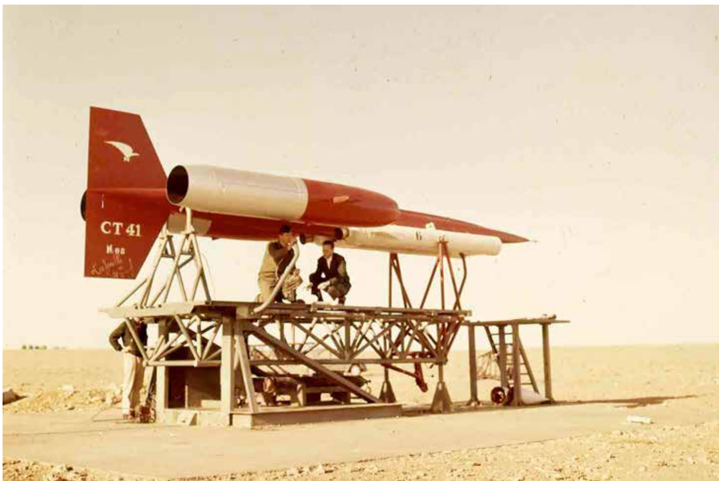
▼ Engin cible supersonique Nord-Aviation CT-41 - Propulsé par statoréacteur, il est abandonné en 1965
