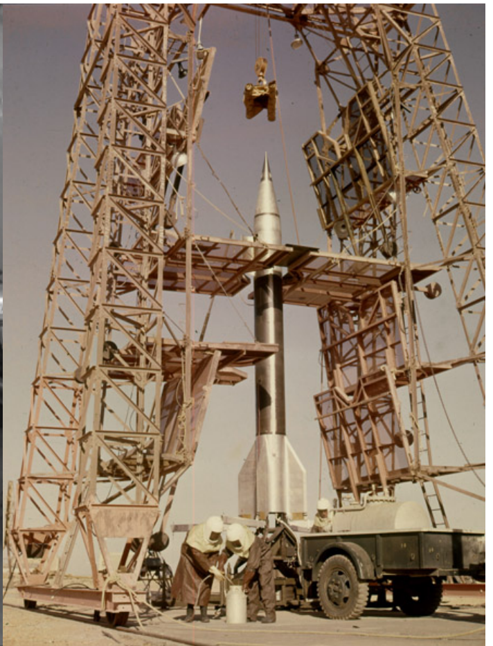
Assemblage final de la fusée Véronique AGI V23 et installation sous le portique, puis le portique est dégagé de la fusée avant son lancement qui sera un échec le 23 février 1960
