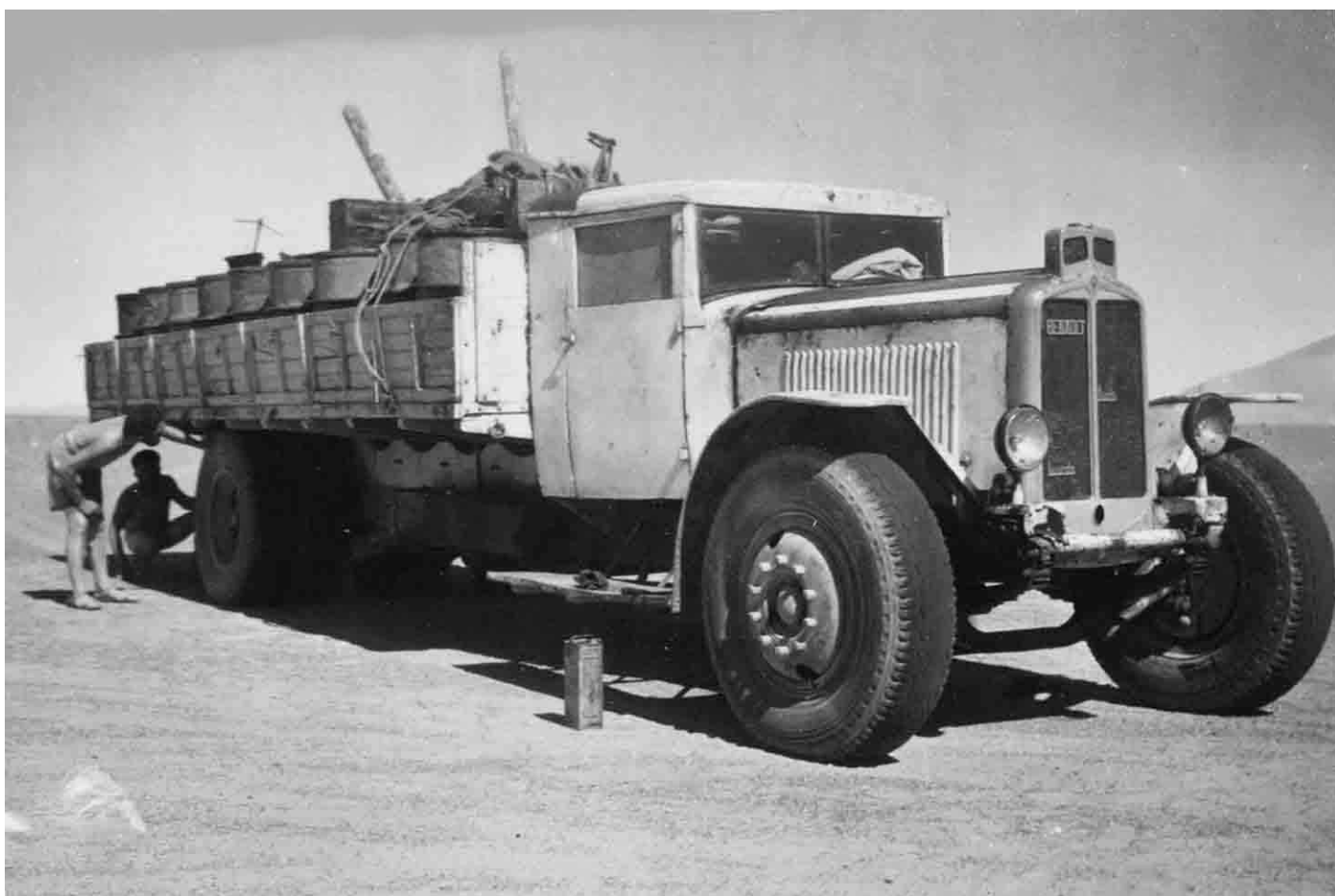
▼ Camion Renault de ravitaillement en essence-avion en 1936 - 7 500 litres, 20 tonnes de poids en charge
