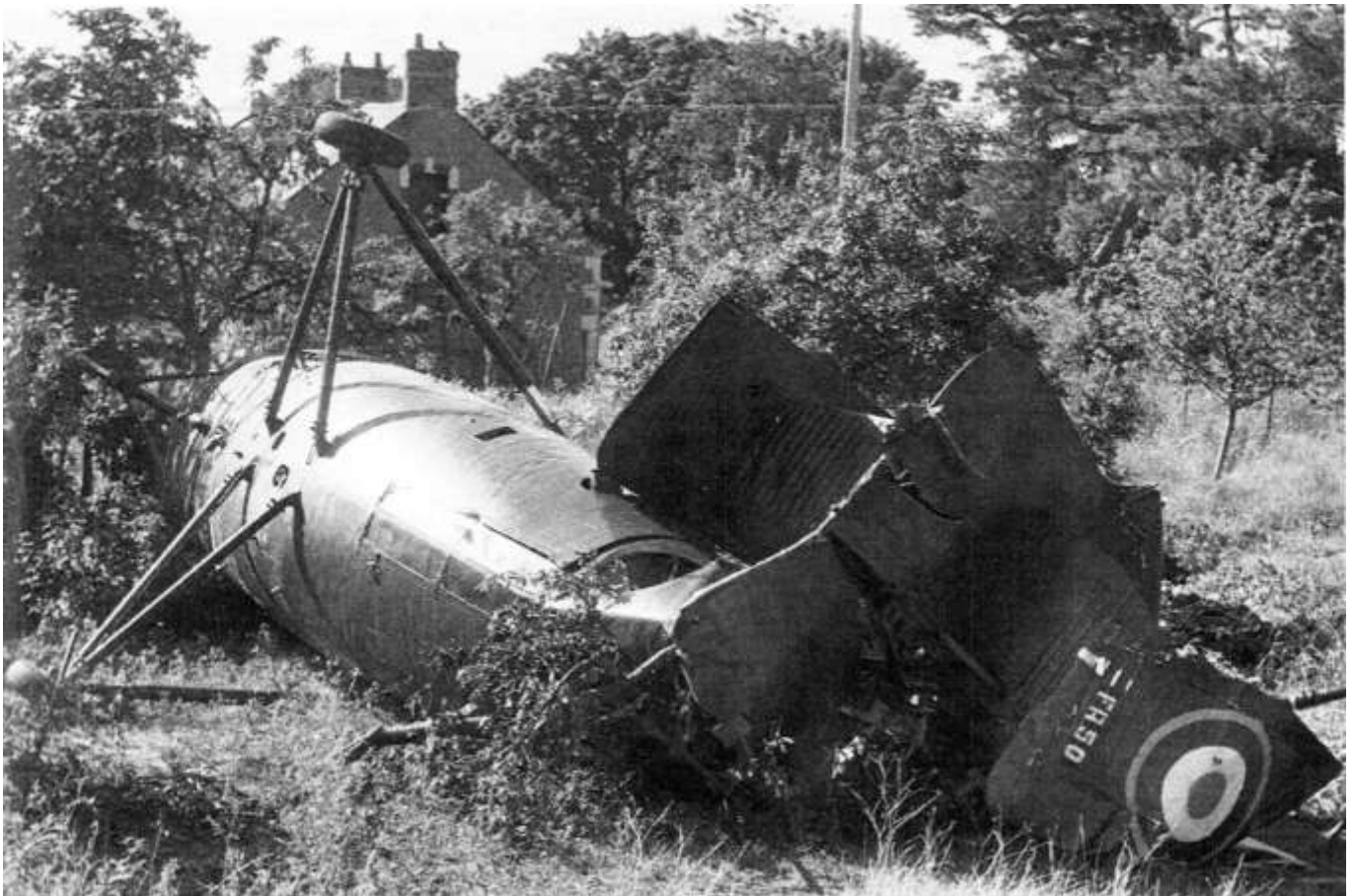
FR50/MDL de l'ESAM. Accidenté le 21 juin 1963 en approche sur la zone de posé en herbe disponible dans l'enceinte de l'ESAM, l'appareil est l'objet d'une baisse de régime significative. L'équipage n'a pas pu éviter la chute et l'écrasement dans un jardin privé de la zone pavillonnaire proche de l'école. Le pilote et le mécanicien sont blessés (photo Jacques Barraquier).
