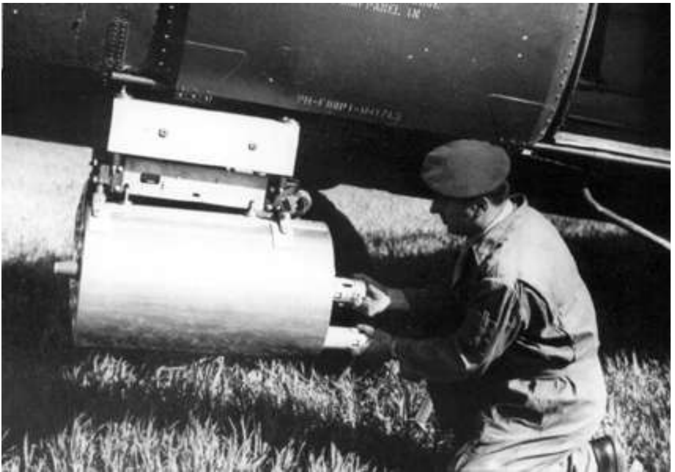
Chargement d'une roquette de 68 mm dans un container Matra 116, lors de l'expérimentation d'avril 1958. On note la pièce rectangulaire blanche permettant l'adaptation entre le support de réservoir supplémentaire du H-21 et le lance-bombe Alkan auquel est fixé le panier. Ce montage ne sera pas retenu dans la version définitive (photo X, via Emmanuel Bosc).
