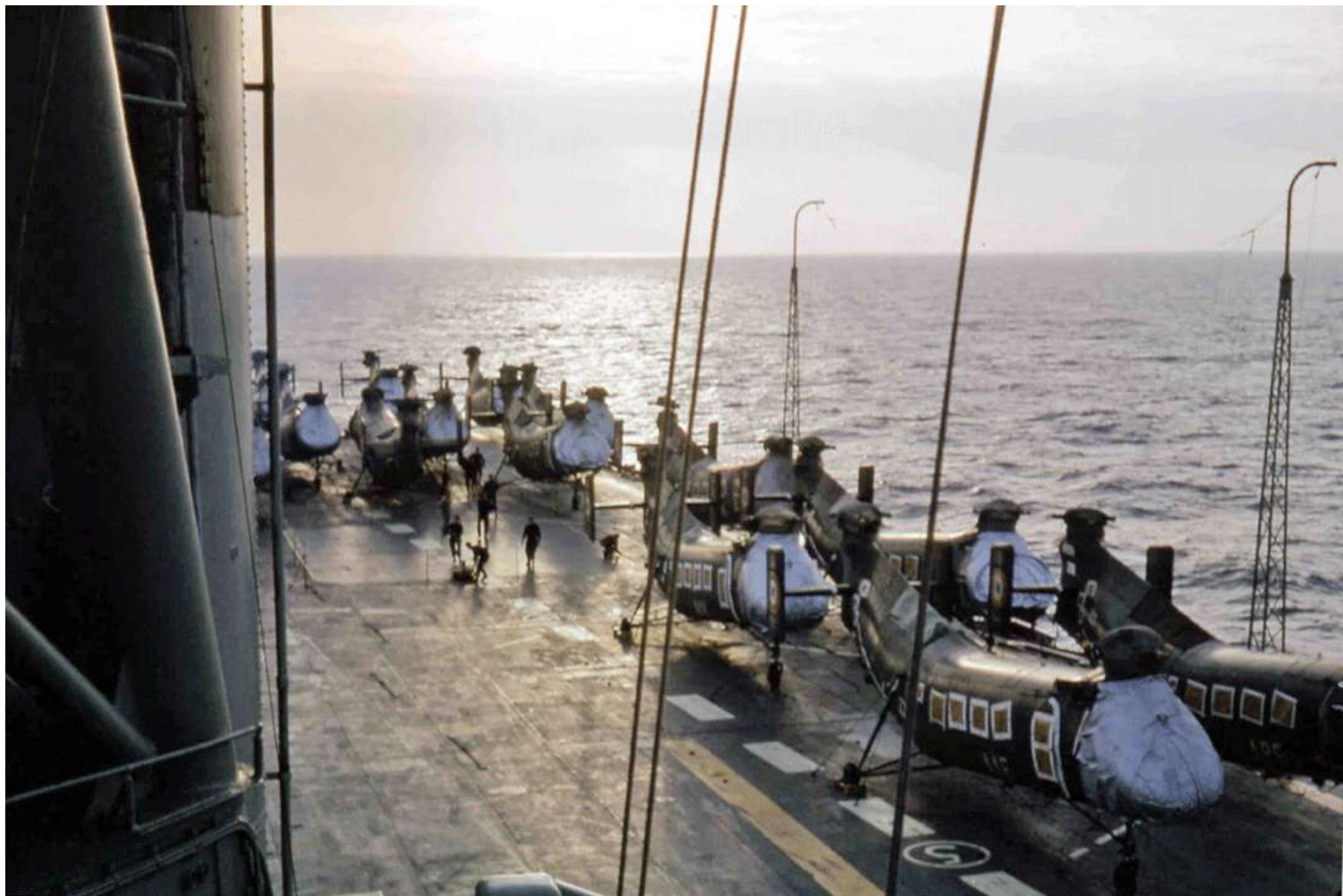
16 H-21C du 14 e GALAT, furent embarqués le 14 janvier 1964 à bord du porte-avions "Arromanches" à Mers-el-Kébir, destination Toulon où ils arrivent le 15. Les "Banane" ont toutes leurs ouvertures calfeutrées pour se protéger de la salinité de l'air marin et leurs pales enlevées (photo (photo Yves Gelebart).
