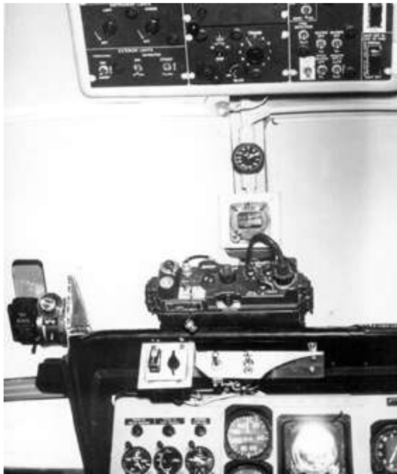
La planche de bord d'un H-21 armé montrant le collimateur installé à gauche de la planche de bord ainsi que les interrupteurs spécifiques à cet usage installés sous le poste radio HF de communication avec les troupes au sol (photo X, via E. Bosc).
