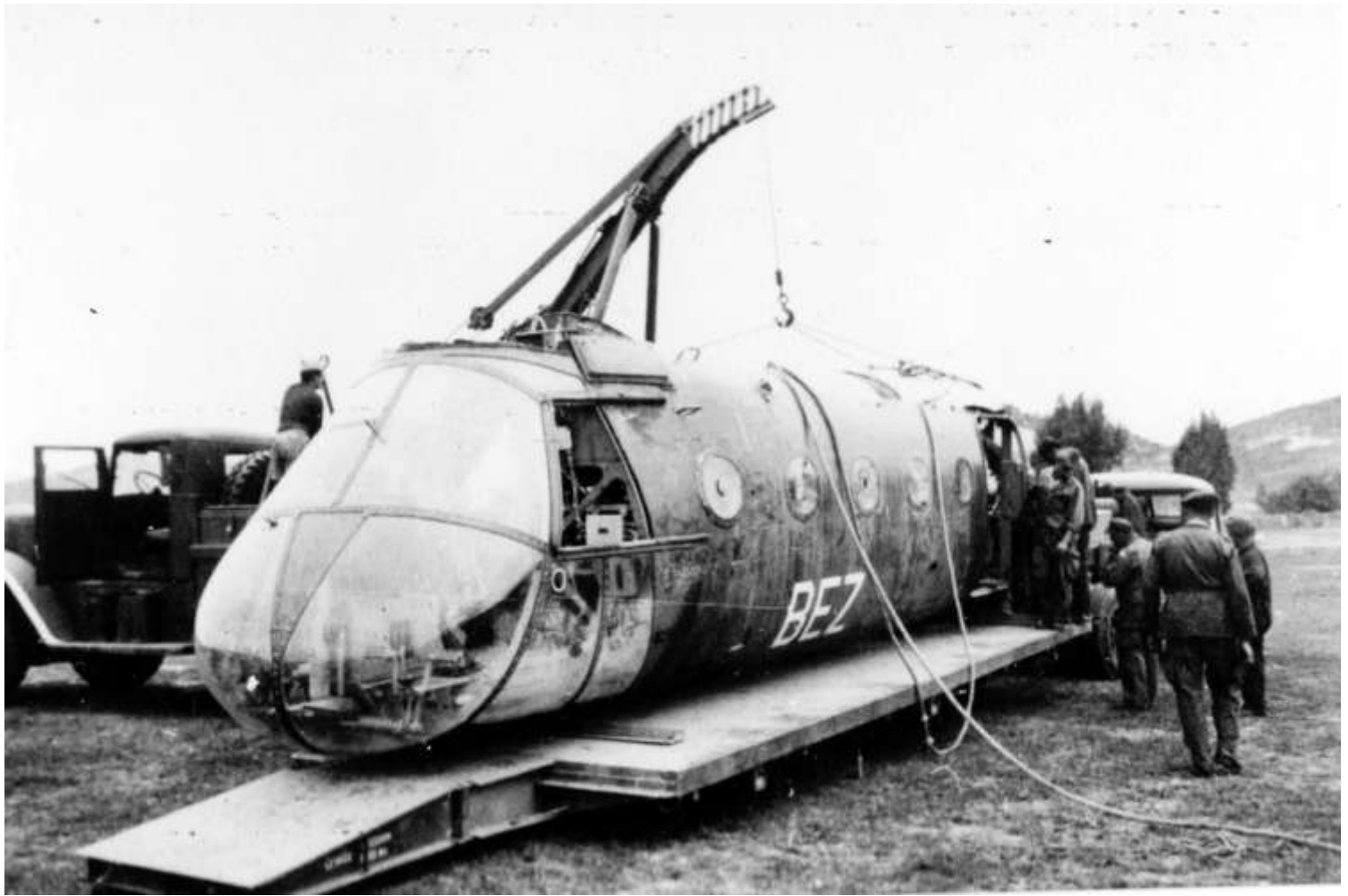
FR70/BEZ. Accidenté à El Milia, le 15 mai 1960. Au posé sur une DZ, l'appareil heurte une souche avec son train droit. Le train arraché, l'appareil se couche sur le côté droit. Reversé à l'AIA (photo Jacques Barraquier).
