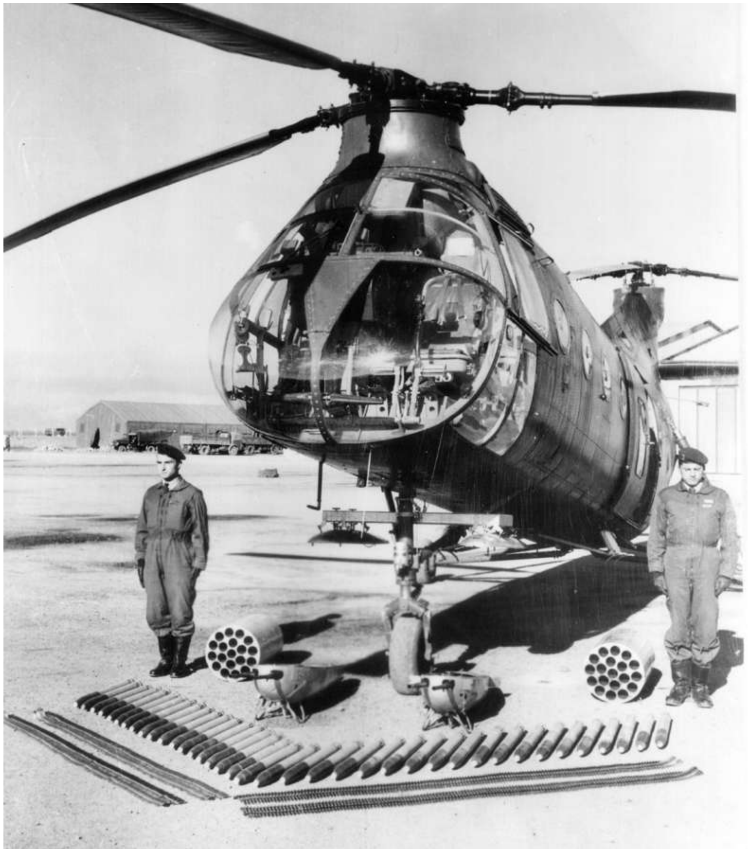
Le montage définitif adopté pour les H-21 de l'ALAT, ici sur l'appareil n° FR44/BED, à Valence, le 2 décembre 1958. Notez sur le bras support des containers SAMM sur le train avant le carénage fermant la forme en goutte d'eau du container, cet élément n'existant pas sur les T-6G où le container était monté affleurant sur l'intrados de l'aile. Le personnage à gauche est le capitaine Cannet, futur général commandant l'ALAT (photo GE.ALAT).
