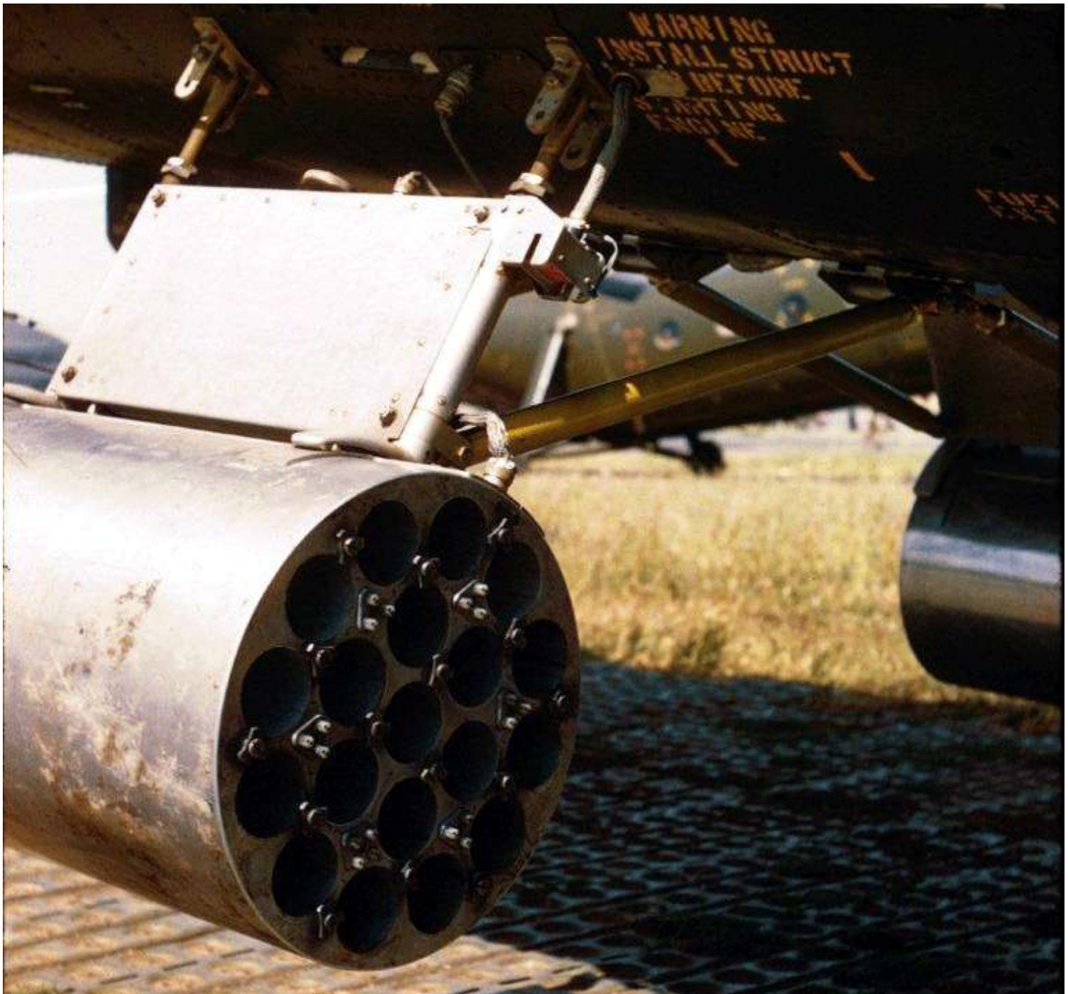
Vue rapprochée montrant le montage définitif des paniers MATRA 116 à 19 alvéoles de 68 mm. On note la présence des renforts obliques de réglage en jaune (photo Pierre Gultzoff).
