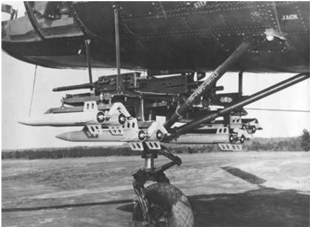
Deux vues d'un bâti expérimenté par l'US Army vue le 23 avril 1957. On note la présence de deux mitrailleuse de 0.30, 2 de 0.50 ainsi que huit roquettes HVAR. Le modèle fourni au GH N°2 était légèrement différent (photo X, via Emmanuel Bosc).
