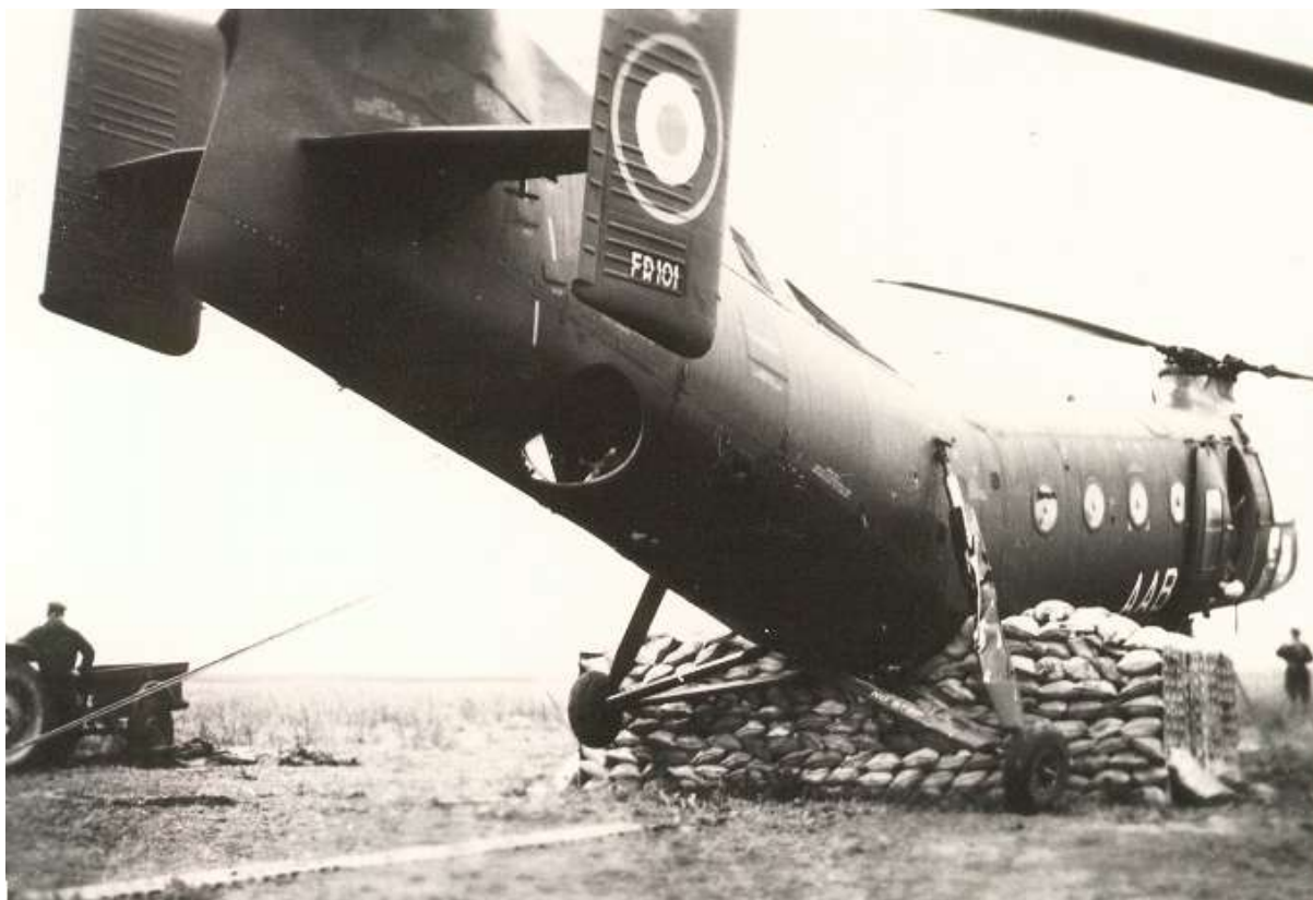
La FR101/AAB vue sur le berceau de crash suite à sa mésaventure du 22 février 1960. On remarque le flambage de l'amortisseur de train principal : le carénage d'amortisseur est chiffonné comme une feuille de papier ! (photo X, via Emmanuel Bosc).
