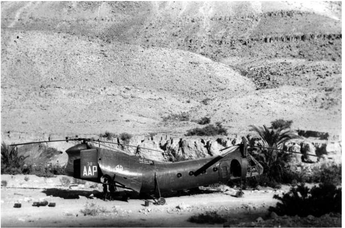
H-21 n° FR38/AAP du GH N°2 en panne de moteur à la suite de l'explosion d'un cylindre à l'atterrissage (photo Roland Jeanjean).
