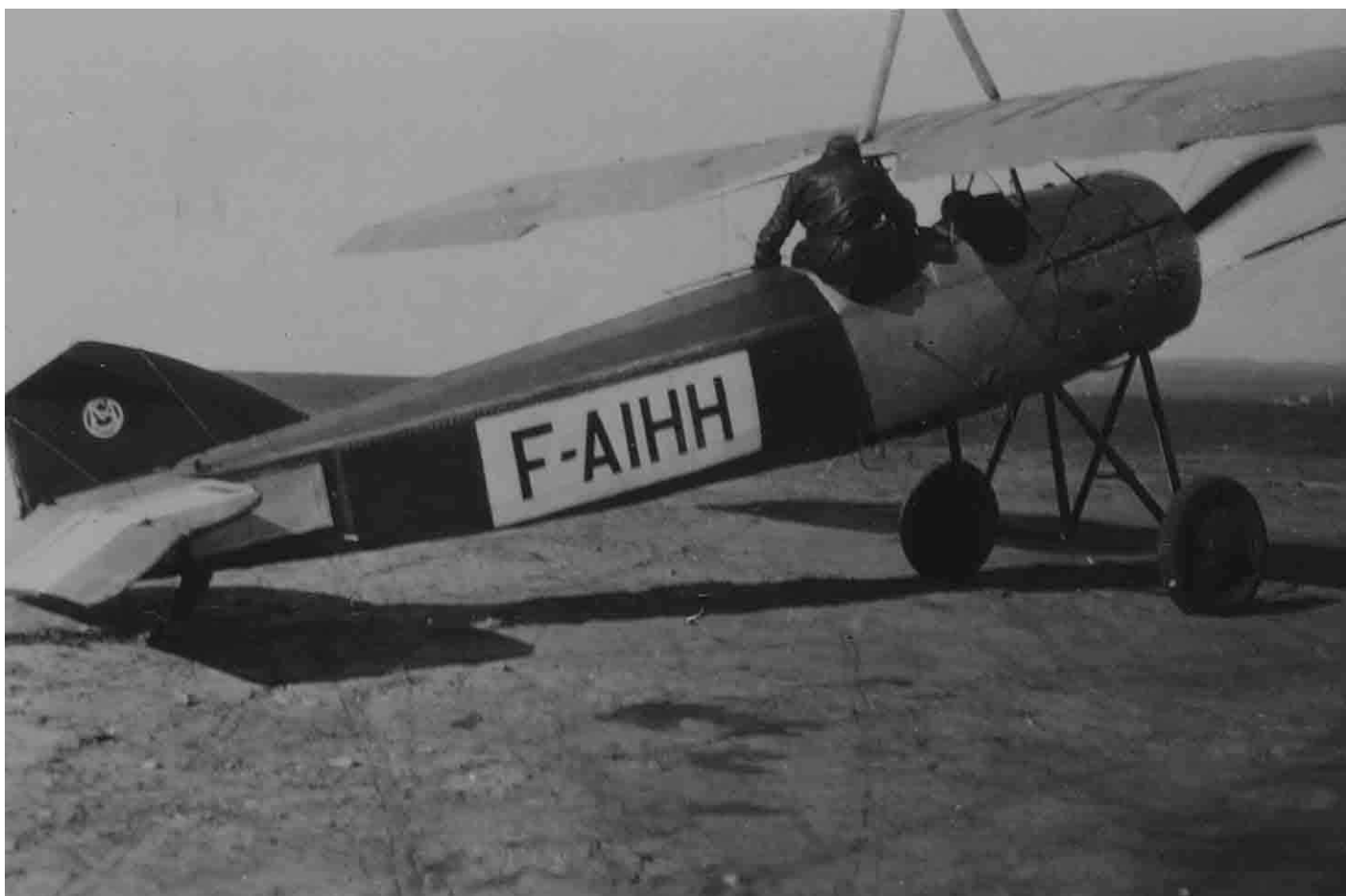
▲ ▼ Le Morane 35 de la Compagnie aérienne français (CAF) à La Sénia, semblable au F-AIJG utilisé par Pierre Monville pour l'école de pilotage de l'Aéro-club d'Oranie. La profusion des cordes à piano assure la rigidité de l'ensemble
