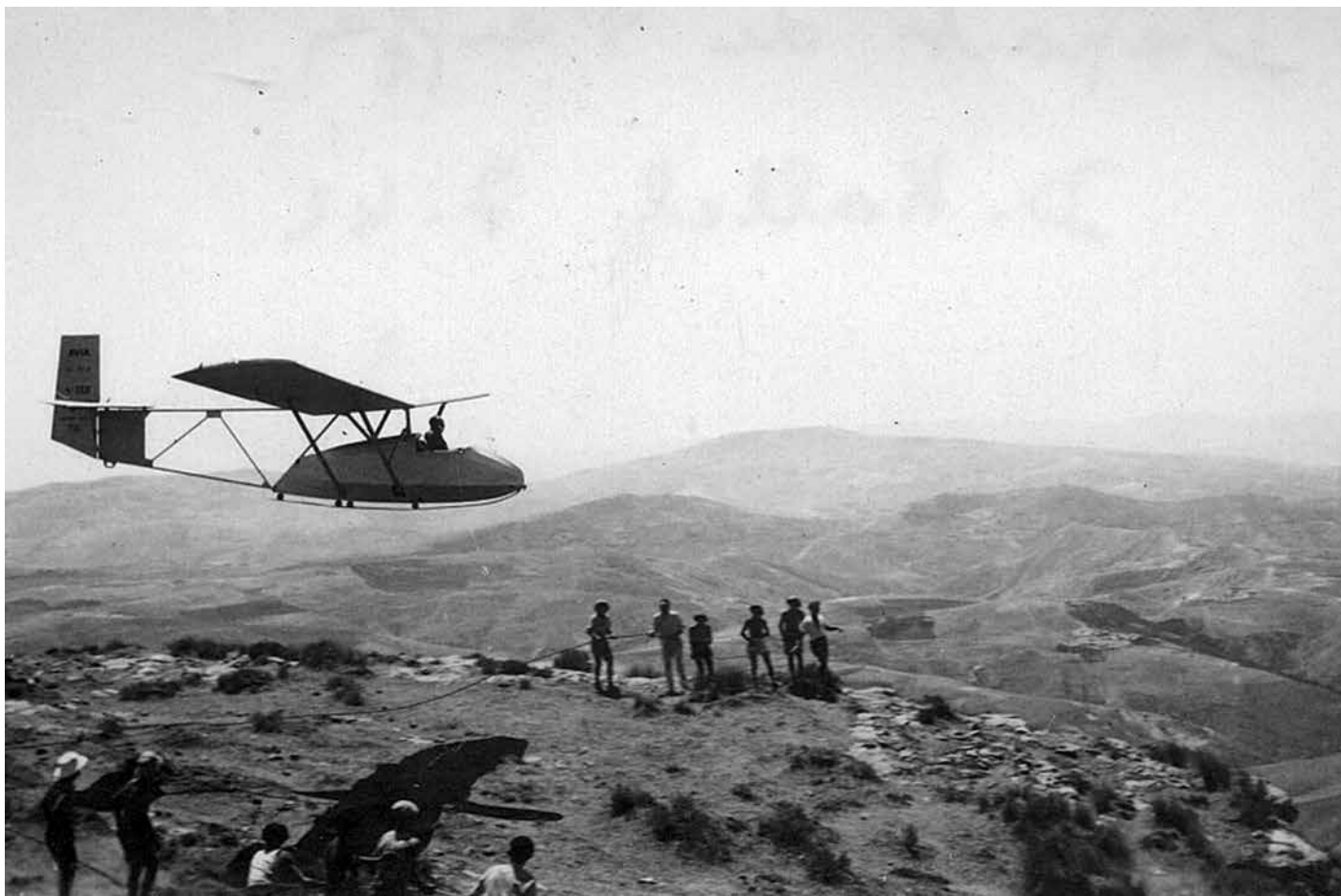
▲ Décollage d'un Avia 152A, les deux équipes, de part et d'autre, viennent de courir et de larguer
