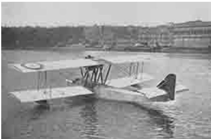
Le Lioré et Olivier LeO H-194, moteur Gnome et Rhône 9ab, 420 ch
