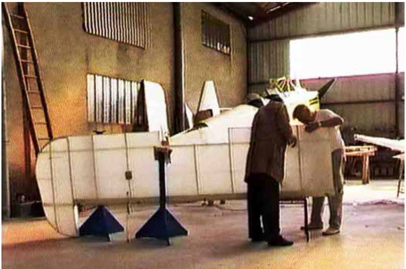
▼ Eugène Bellet et Michel Barbié à l'entoilage
