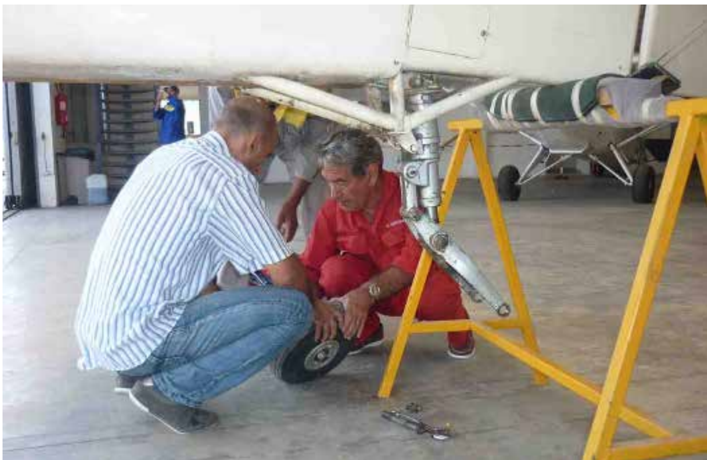
▼ Alain Bertrand occupé par la réparation de la roulette de queue du Breguet à Casablanca
