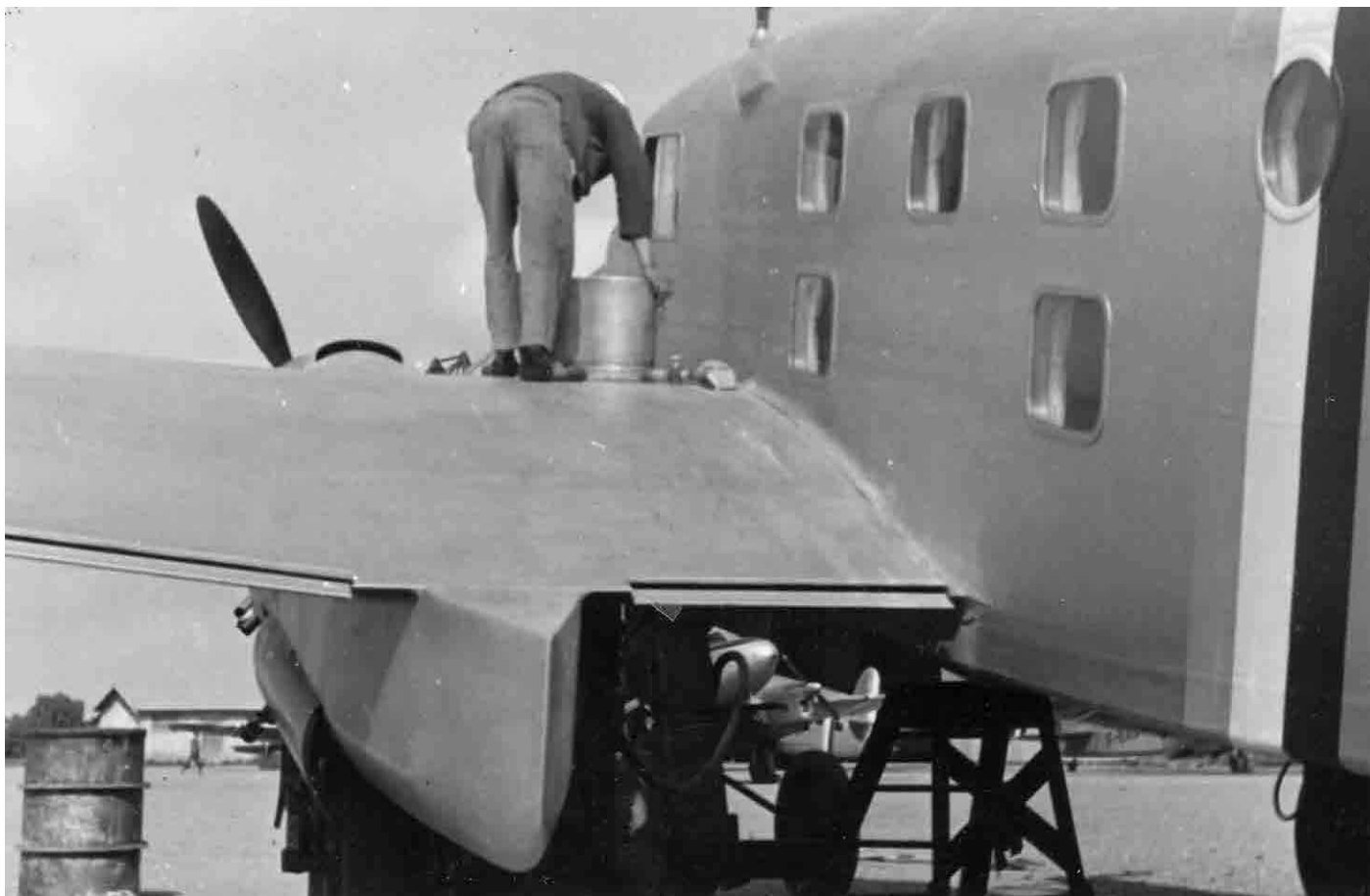
▲ SCLA à Maison-Blanche. Caudron C.447, version ambulance du Goéland, reconnaissable aux deux rangées de hublots. Il peut transporter un infirmier et quatre blessés sur civières
