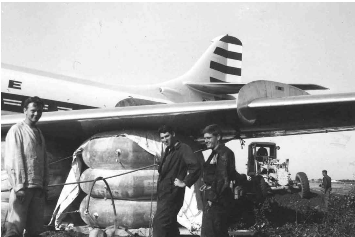
▲ ▼ Le 21 avril 1962, à Maison-Blanche, une Caravelle sort de piste et fauche son train d'atterrissage. Les moyens de la base d'Aéronautique Navale de Maison-Blanche sont mis en œuvre pour la sortir de cette fâcheuse situation
