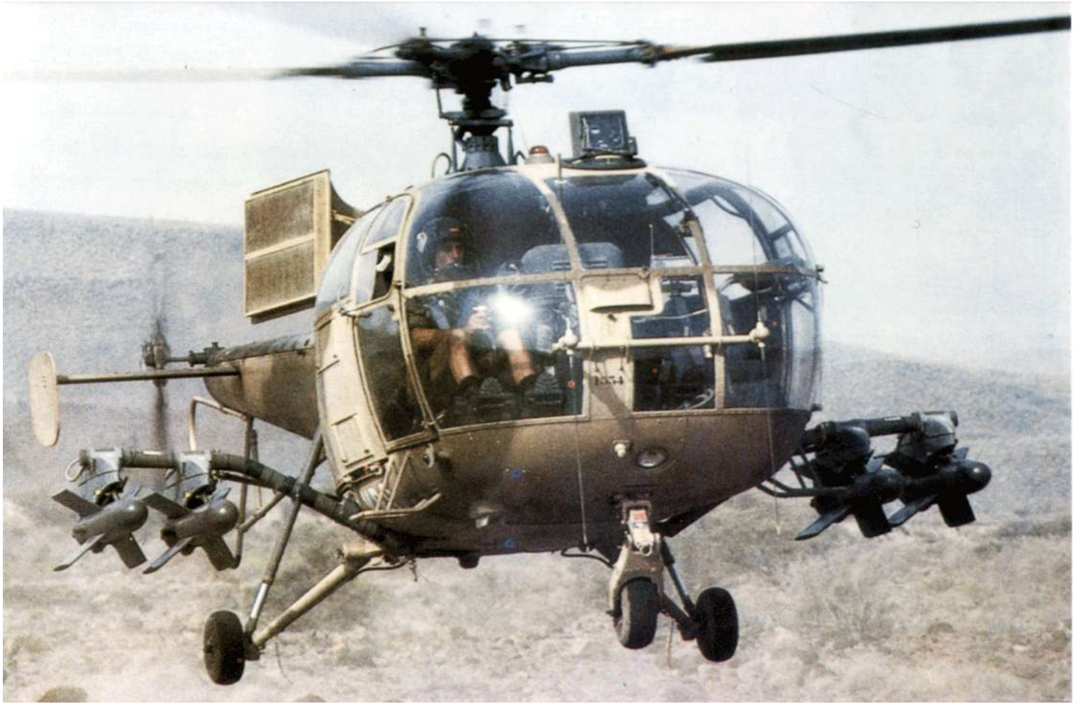
Alouette III n° 1534/KBC en 1980. Appareil avec ses filtres à sable et sa livrée camouflée caractéristiques du Detalat de Djibouti (photo Alain Crosnier).
