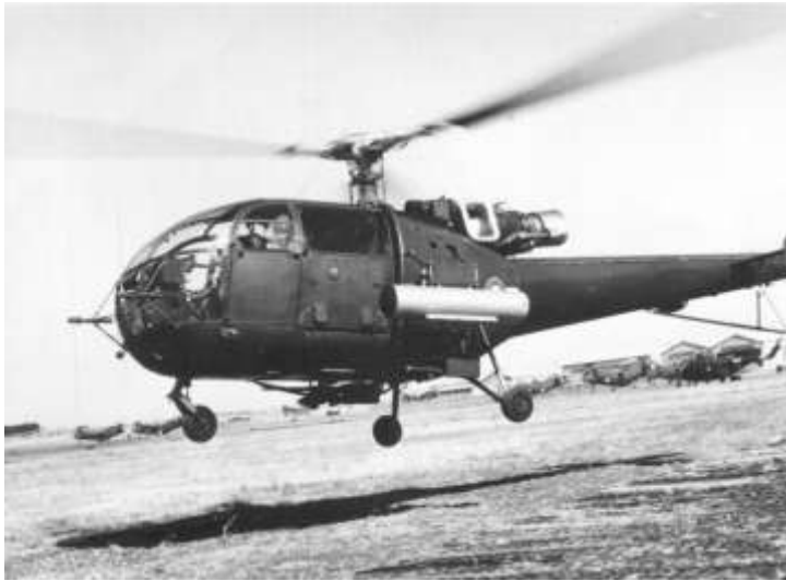
L'Alouette III présérie n°02 en expérimentation en Algérie, au sein du GH N°2 en 1961. L'armement est composé de deux paniers de roquettes à 36 alvéoles de 37 mm et de deux mitrailleuses de 7,5 mm (photo collection Emmanuel Bosc).
