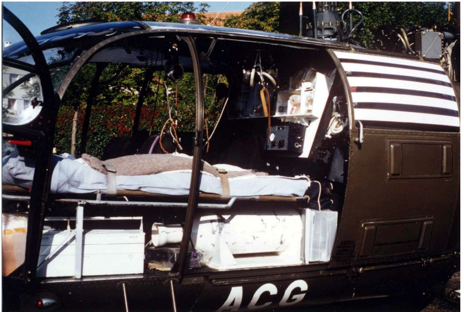
Alouette III, codée ACG, du Galdiv 8, détachée à Montpellier en 1975. Avec un équipement différent de celui des années précédentes. En effet, cette fois, la civière est dans l'axe de la machine pour permettre la présence de deux soignants à l'arrière (photo Jean-Paul Enrico).
