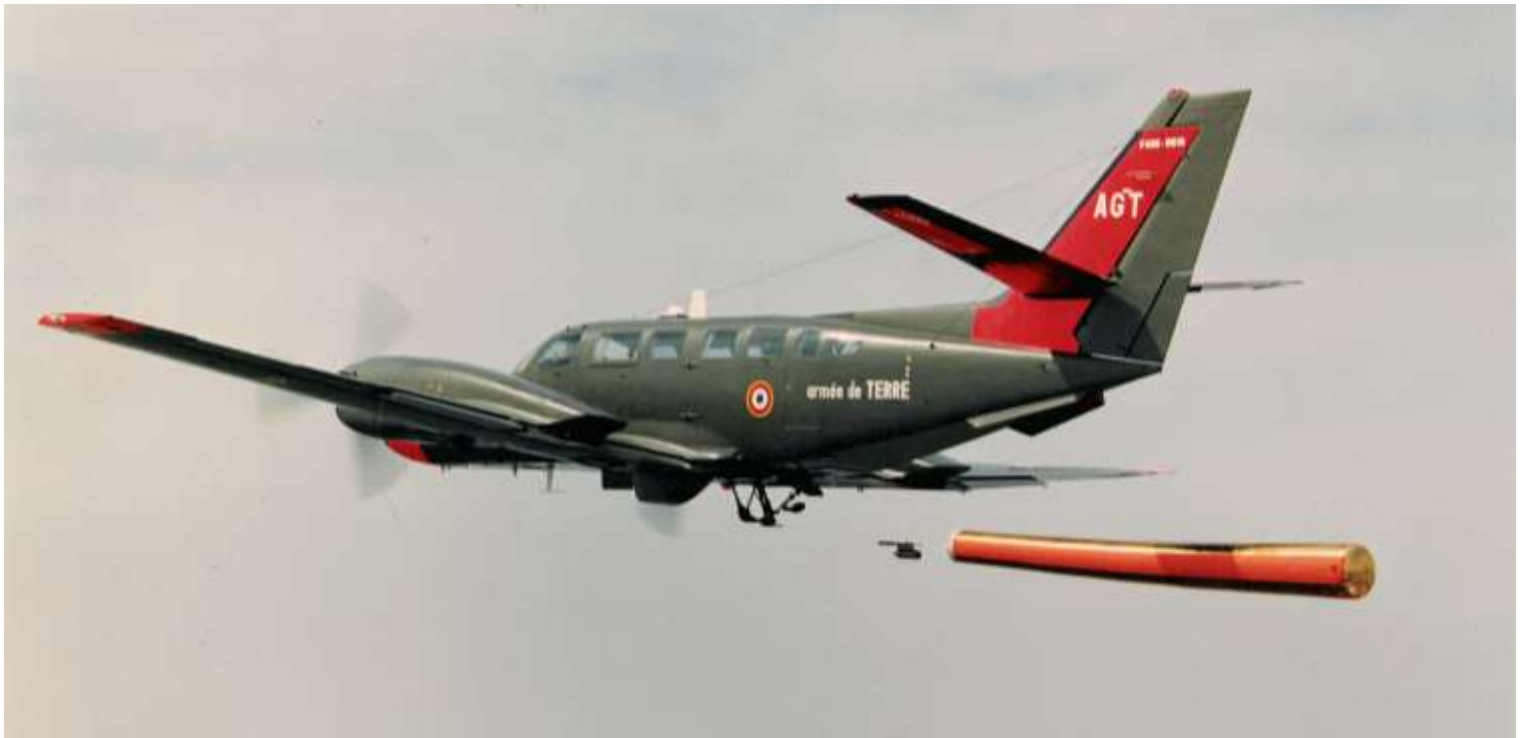
F-406 n° 0010/AGT du 3 e GHL remorquant une manche à air servant de cible (photo CEV, via Christian Malcros).
