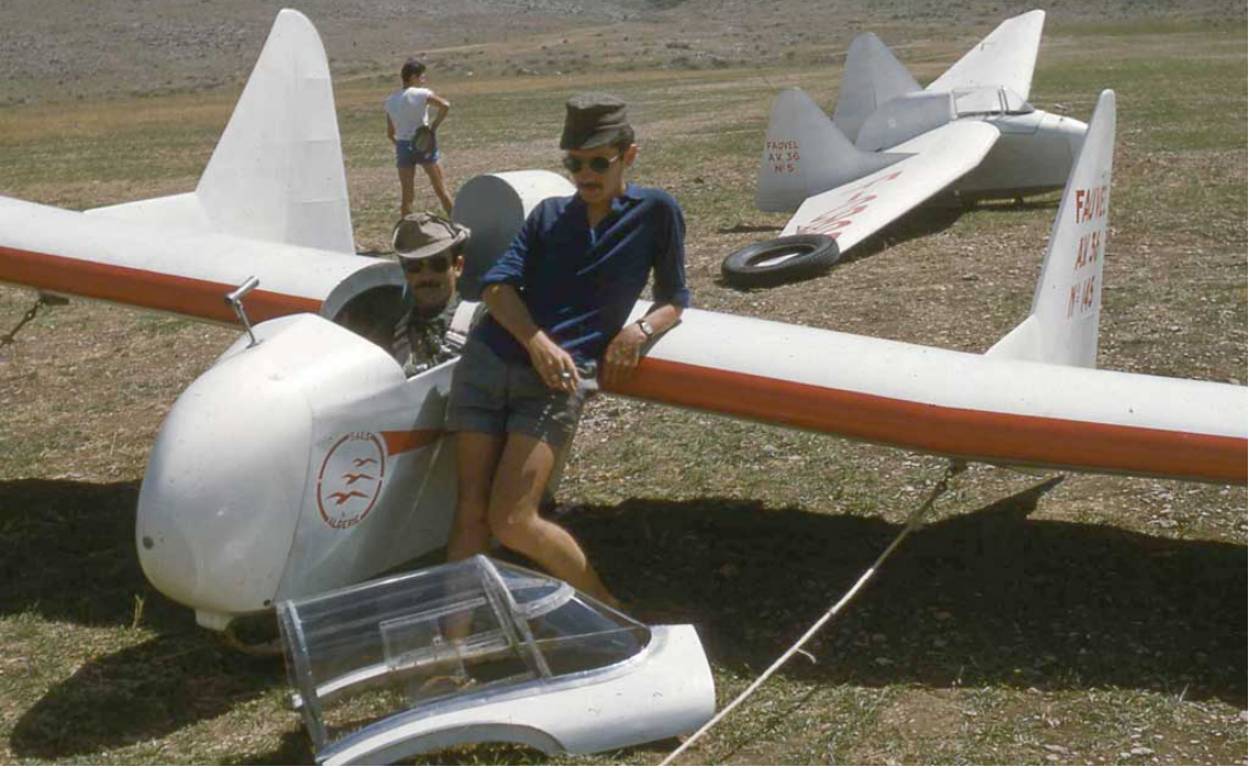
Une Aile Volante prête à être treuillée – Remarquer le câble en V qui relie les deux crochets d'aile au câble du treuil – Juin 1960
