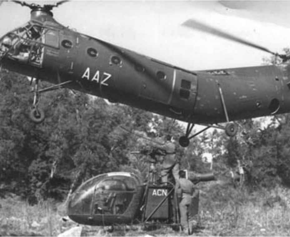
Préparation pour l'enlèvement d'une Alouette par une Banane à l'aide d'une élingue (Francis Fontaine)
