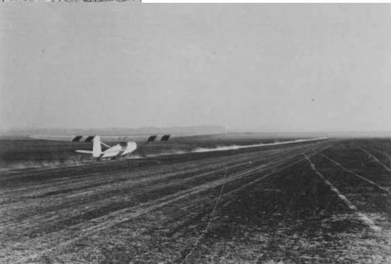
Décollage du C 800 au treuil à El-Aouedj – La voiture de piste ramène les câbles (Henri Deloupy)
