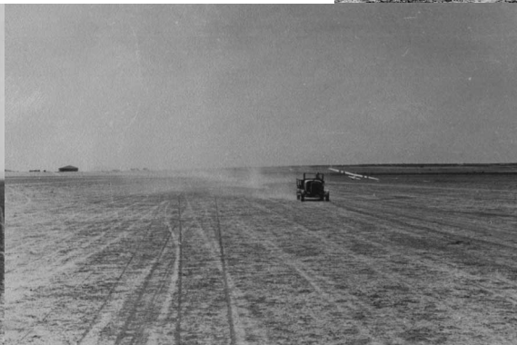
Décollage du C 800 au treuil à El-Aouedj – La voiture de piste ramène les câbles (Henri Deloupy)
