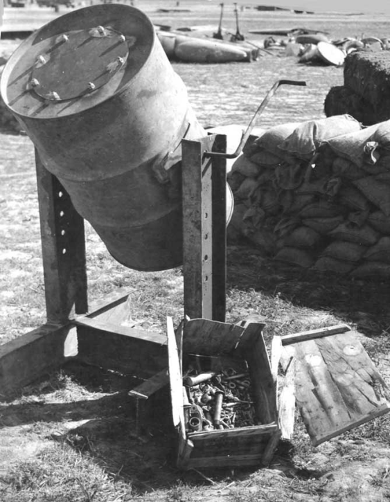
Système de nettoyage des petites pièces
