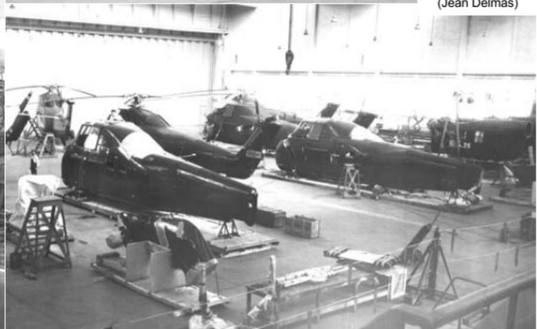
Sikorsky H-19 et H-34 de l'armée de l'Air et de l'ALAT et HSS de l'Aéronautique Navale dans le hall d'assemblage
