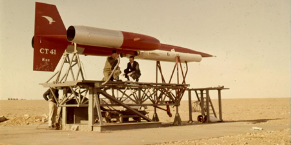
Engin cible supersonique téléguidé Nord-Aviation CT 41 Narval équipé de deux fusées à poudre et de deux statoréacteurs
