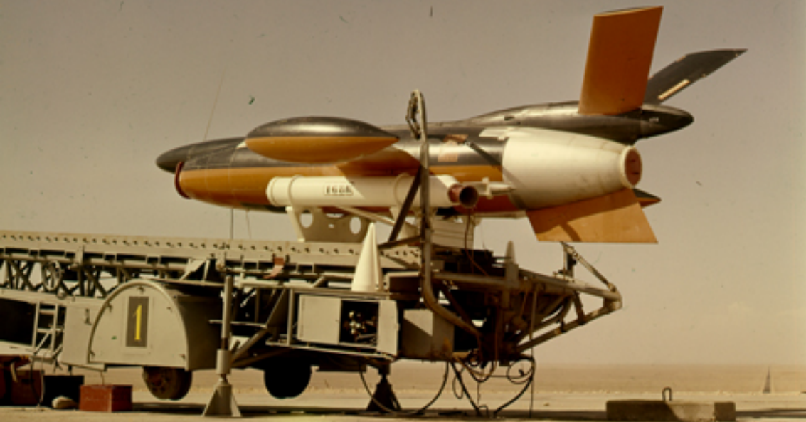
Engin cible téléguidé Nord-Aviation CT 20 (ex-Arsenal 5510) en mars 1960. Il est équipé d'un réacteur Turboméca Marboré
