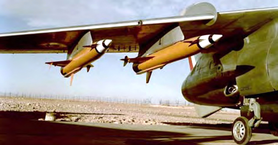
Missile air-air MATRA R 511, à guidage par radar, sous une aile de Vautour IIN du CEV
