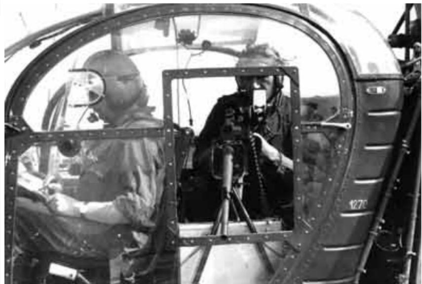
Le PMAH 19ème DI a été spécialisé dans les essais d'armements nouveaux sur les L-19, les *Alouette* II et l'*Alouette* III dont il a mis en œuvre le seul exemplaire utilisé en Algérie. Ci-contre et ci-dessus, essai d'une mitrailleuse AA-52 sur une *Alouette* II (Jean-Pierre Meyer)
