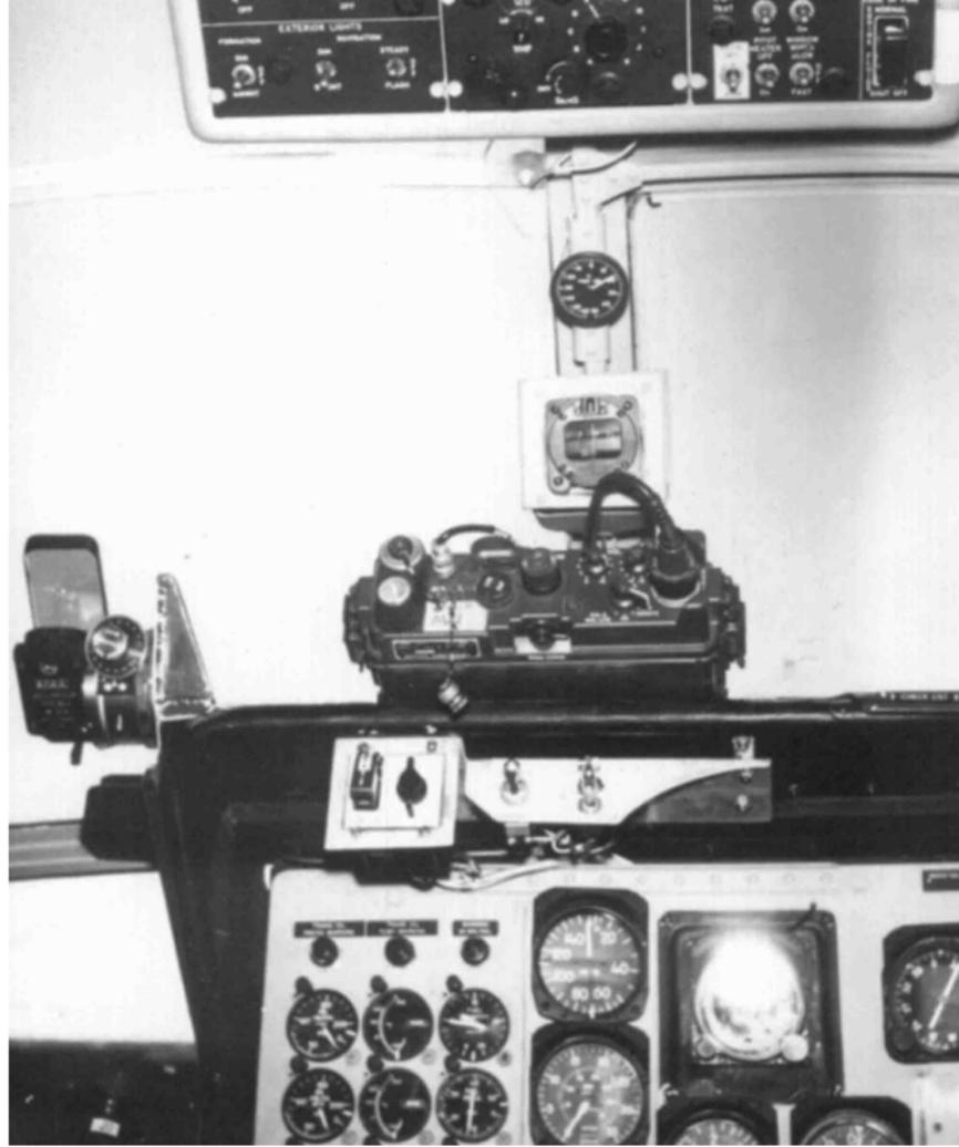
La planche de bord d'un H-21 armé montrant le collimateur installé à gauche et les interrupteurs sous la radio HF
