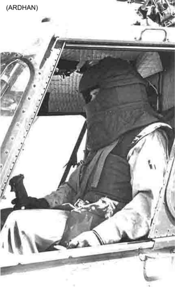
Essai de protection du pilote
