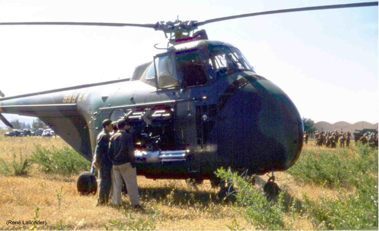
Le Corsaire 2<sup>ème</sup> version est enfin équipé de trois mitrailleuses de sabord Mac 34 de 7,5 mm (deux à gauche et une à droite), alimentées de 100 cartouches. La faible puissance du H-19 fera abandonner ces projets au profit du H-34
