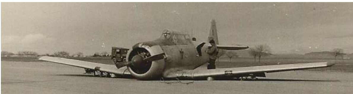
Atteint par un tir des rebelles le train d'atterrissage n'a pu sortir et le T6 a été obligé de se "crasher"
