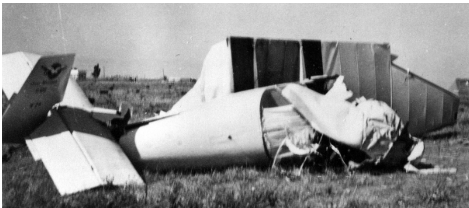
▼ Le série noire continue. Le 29 juin 1957, Pierre Llopis et Marcel Jaulin sont gravement blessés dans l'accident du Jodel F-OAZF pris dans la turbulence de sillage d'un DC4 d'Air Algérie (L.O)
