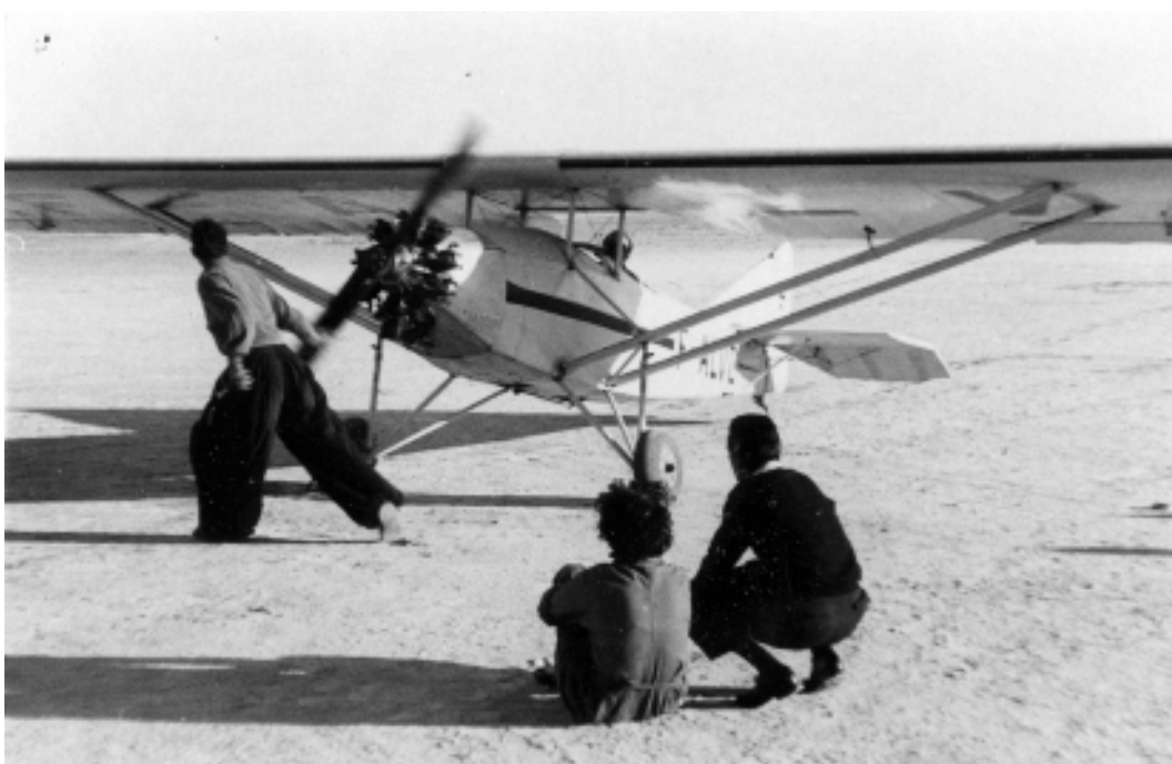
Lancement à la main de l'hélice du Caudron 109 F-ALVC, démunie de toute installation électrique (GC)
