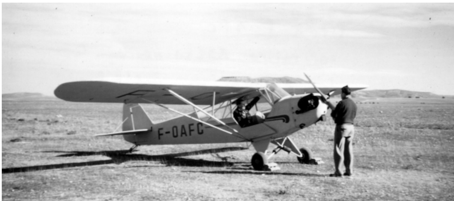
▼ Le Piper Cub de l'Interclub (CL) Le Piper Cub, ou L4 Grasshopper dans l'armée américaine qui en utilisa un très grand nombre comme avion d'observation durant la guerre, est construit en tubes entoilés. Envergure : 10,73 m Longueur : 6,78 m Hauteur : 2,03 m Surface portante : 16,50 m 2 Masse à vide : 290 Kg Masse en charge : 500 Kg Vitesse maximale : 150 Km/h Vitesse de croisière : 110 Km/h Plafond : 3 660 m Rayon d'action : 400 Km Moteur : Continental A65, 65 ch.
