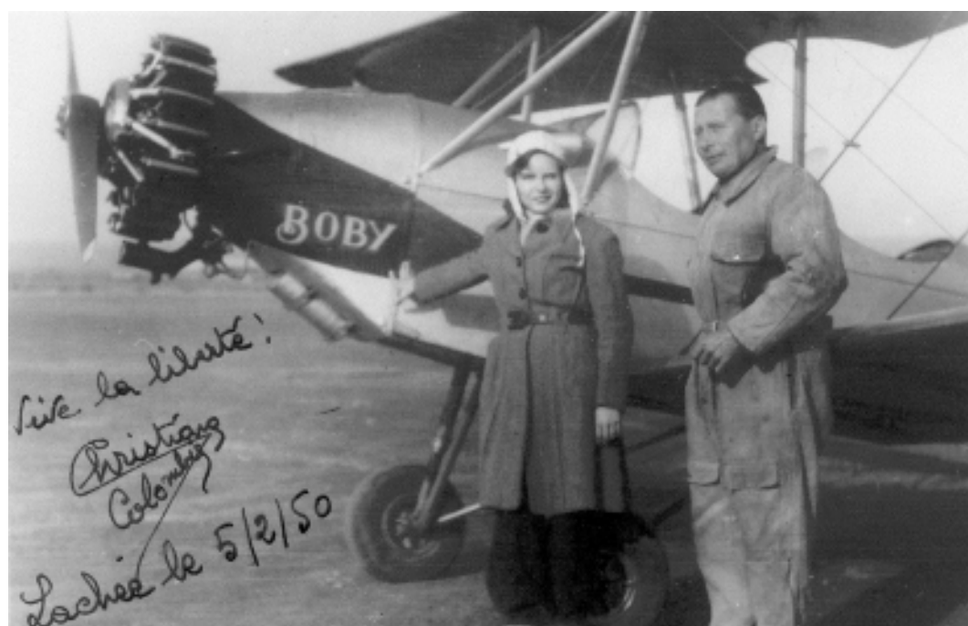
Christiane Colombier-Duplan, le jour de son lâché, avec Pierre Rastaing, devant le Leopoldoff (MH) Envergure : 8,70 m Longueur : 6,10 m Surface portante : 16,5 m 2 Masse à vide : 275 Kg Masse en charge : 550 Kg Vitesse maximale : 170 Km/h Vitesse de croisière : 140 Km/h Rayon d'action : 750 Km Moteur : Salmson 9 Adr 60 ch.
