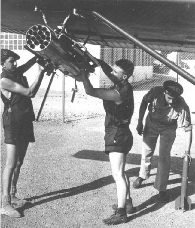
PMAH 19 ème DI – Montage d'un panier de roquettes sur un L-19, 1961
